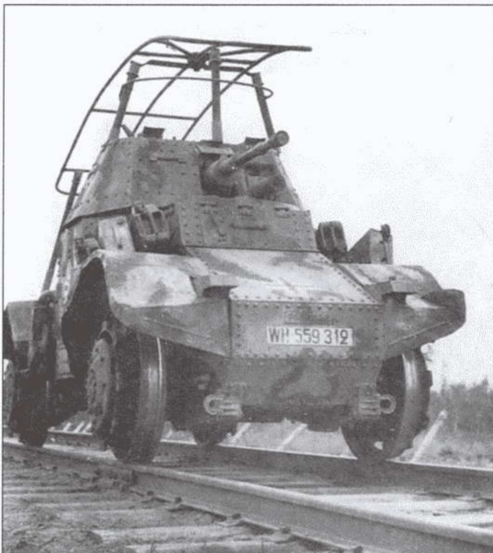
Французский бронеавтомобиль «Панар» 38(t) на железнодорожных колесах
