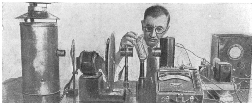
Фотоэлектрический браковщик бутылок инженера Эдриена. Слева, в большом цилиндрическом сосуде — лампа. Справа, рядом с бутылкой — фотоэлемент. Аппарат обнаруживает внутренние напряжения в стекле бутылок.
