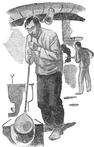
Стеклодув выдувает шар, который потом превратится в бутылку.
