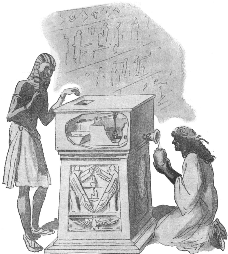
Автомат, продающий «святую» воду в древнем Египте. Изобретен египетскими жрецами.
