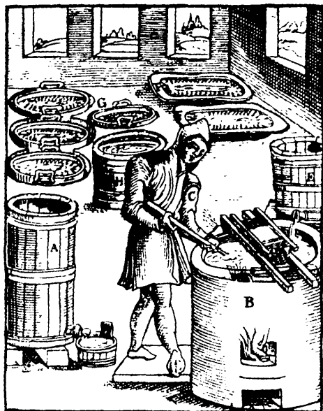
Добыча селитры (из книги Л. Эркера, 1574 г.) ... В — выпаривание раствора селитры; ... F—G — кристаллизация селитры из растворов.
