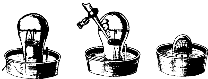
Приборы для демонстрации изменений в составе воздуха (из работы Дж. Мэйю). Слева направо — при погружении железа в азотную кислоту; при сжигании камфоры с помощью нагревательной линзы; при дыхании животного (все опыты проводятся в закрытых объемах воздуха).
