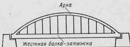
Схемы железобетонных арок «с ездой понизу».
