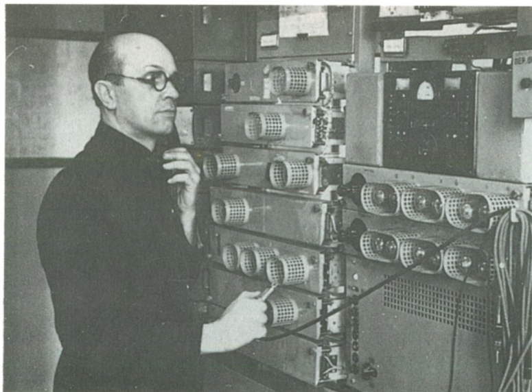
В 1946 году связистами смонтирована высокочастотная телефонная аппаратура МЕ-8. Старший электромеханик Кунгурской дистанции сигнализации и связи А. И. Грошев контролирует работу аппаратуры.
