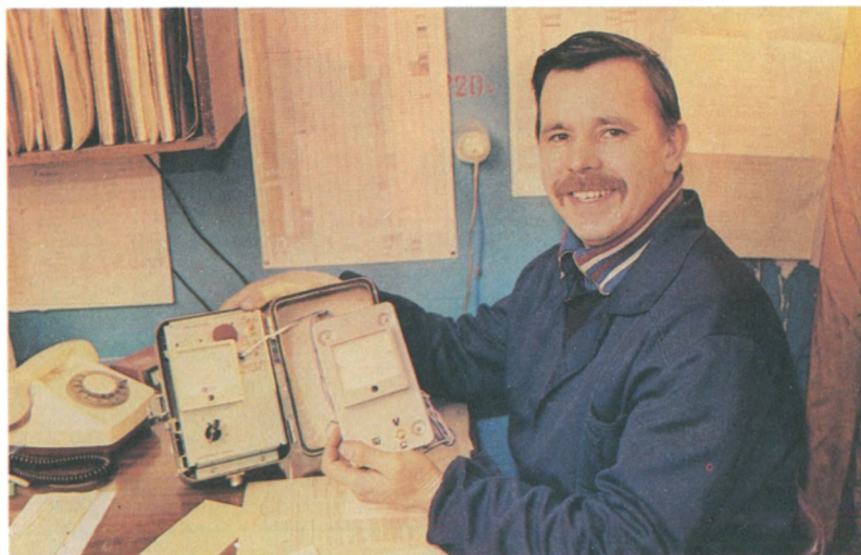
Мастер радиоцеха локомотивного депо Пермь-Сортировочная, лучший рационализатор Свердловской железной дороги за 1988 год В. М. Берсенеv демонстрирует прибор для проверки блоков САУТ на электровозе и прибор для проверки датчиков контроля боксования.
