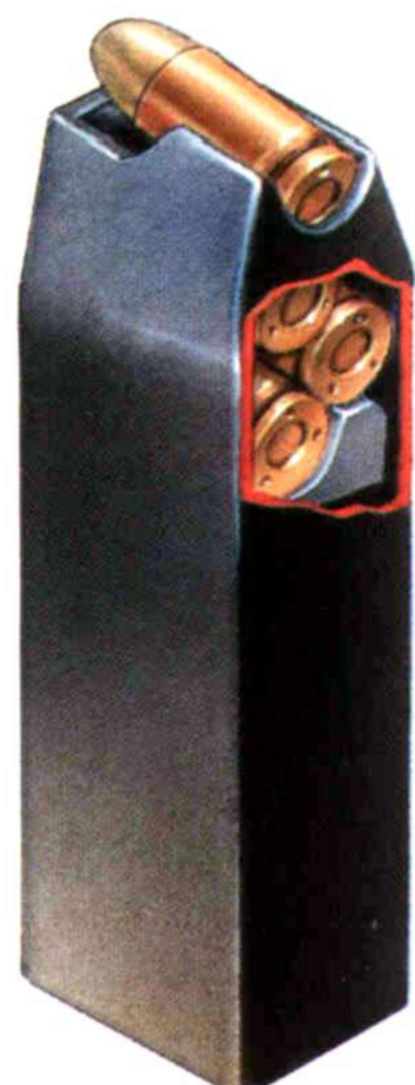
Коробчатый магазин к пистолетам-пулеметам MP.38 и MP.40 с двухрядным расположением патронов и с выходом их на подачу в один ряд.
