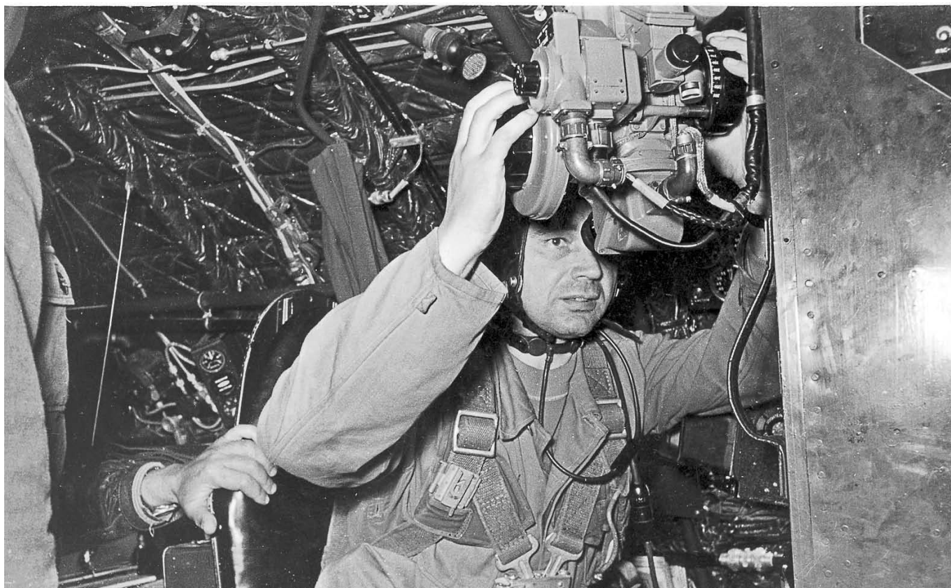
Штурман самолета Ту-95 определяет координаты по приборам астронавигации
