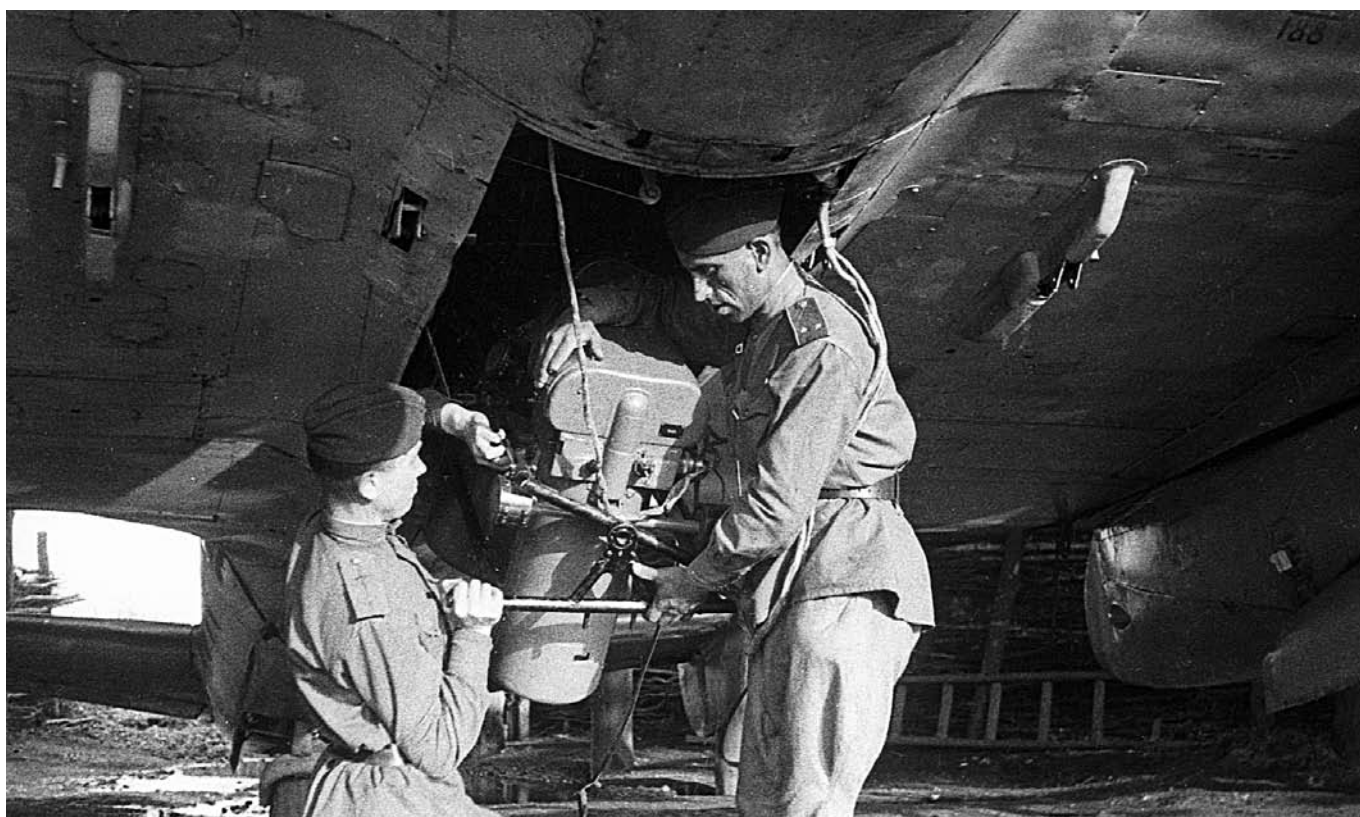
Установка широкоформатного фотоаппарата на самолет-разведчик Пе-3
