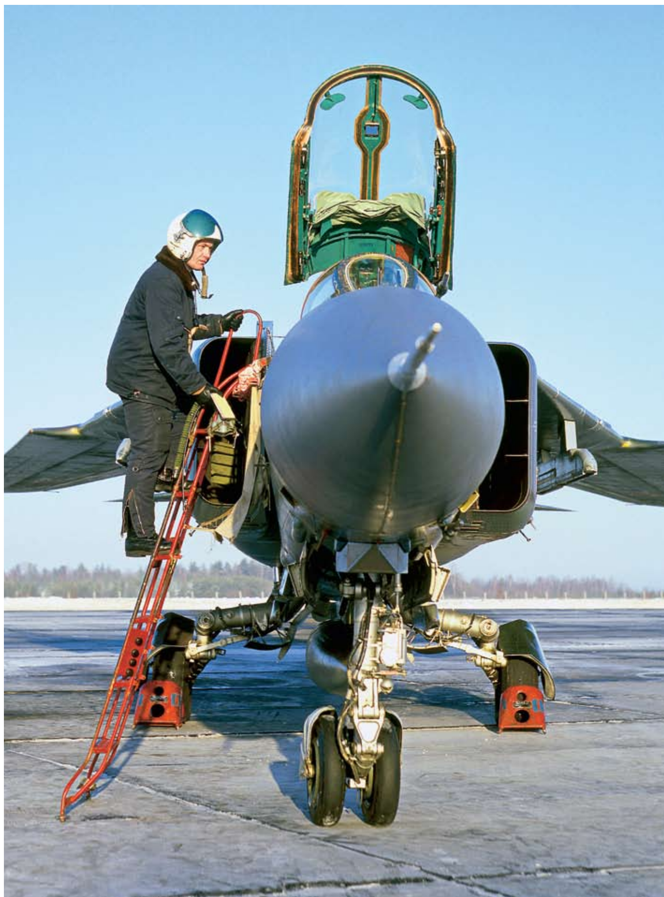
Истребитель с крылом изменяемой стреловидности МиГ-23МЛ
