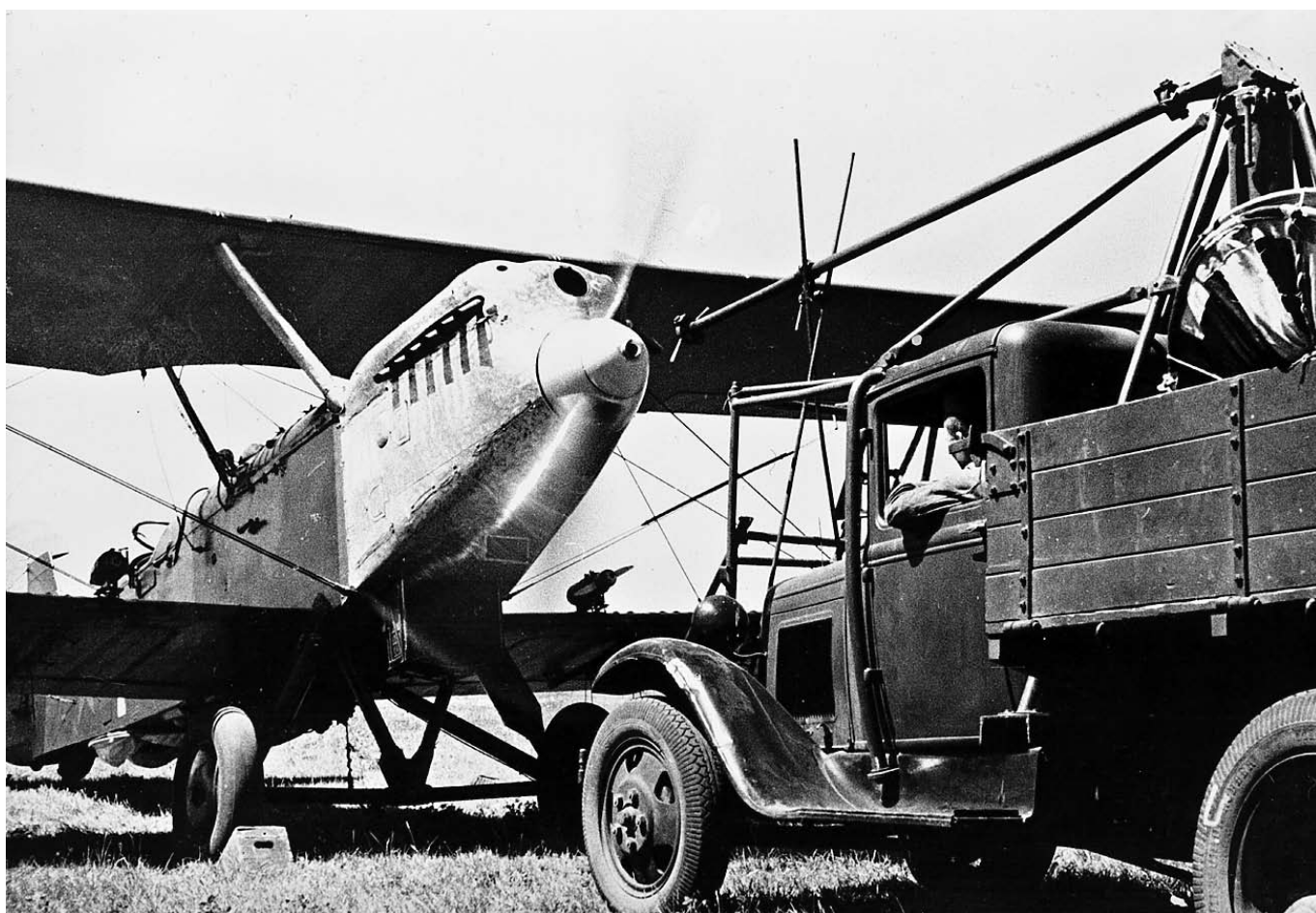
Запуск двигателя с помощью автомобиля-стартера
