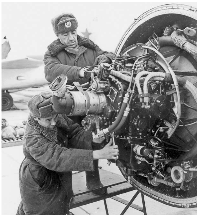
Обслуживание двигателя бомбардировщика Ил-28
