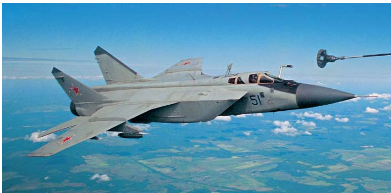
Самолет МиГ-31 снабжен системой дозаправки в воздухе
