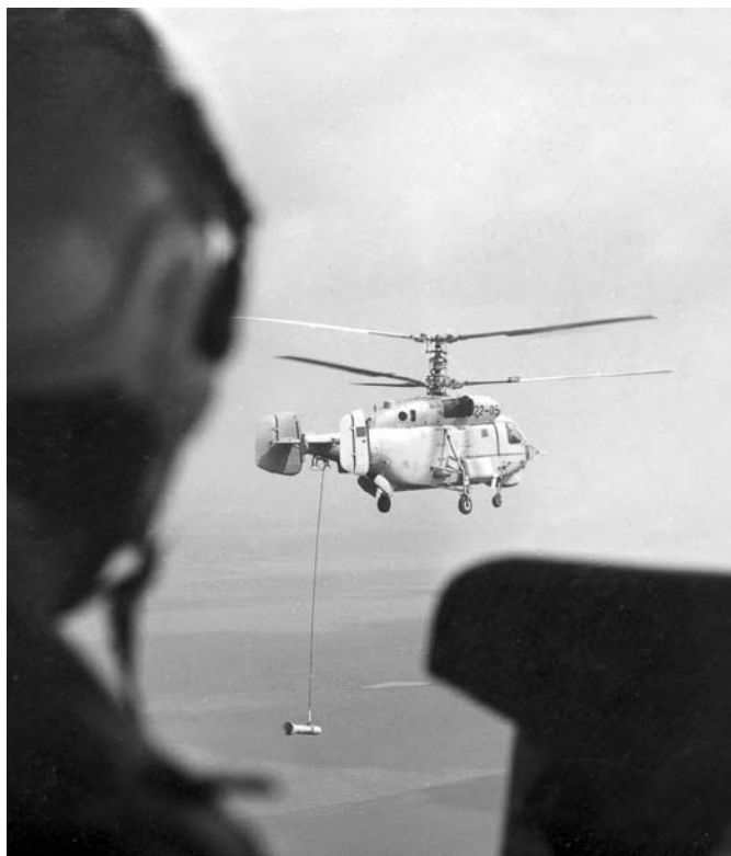
Экипаж Ка-27 опускает магнетометр для поиска подводных лодок
