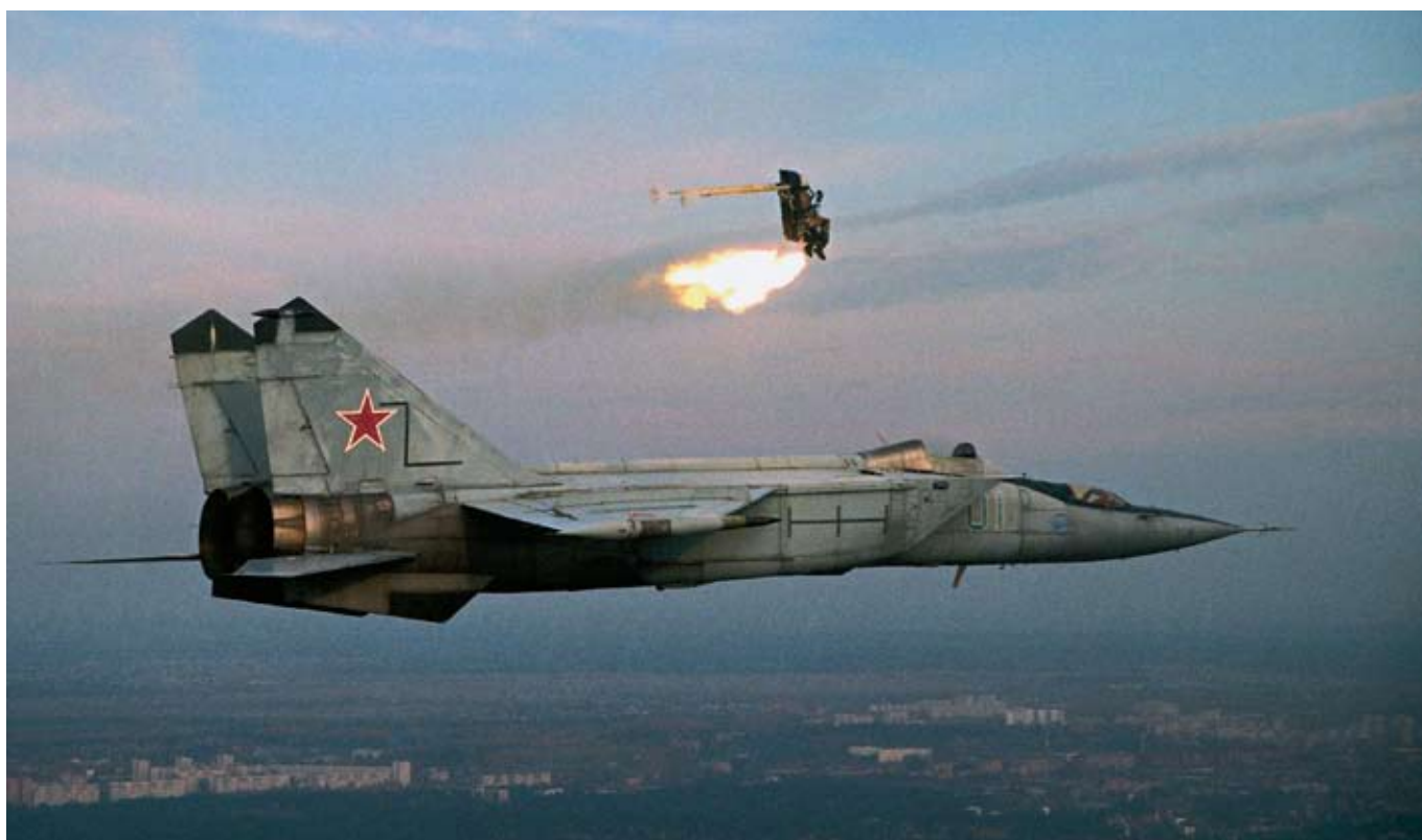
Проверка работы системы катапультирования на манекене на самолете МиГ-25У
