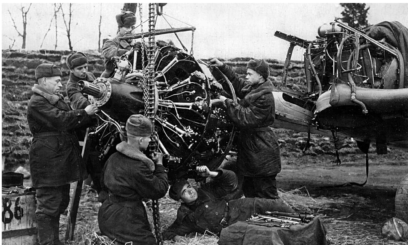
Полевой ремонт мотора истребителя Ла-5
