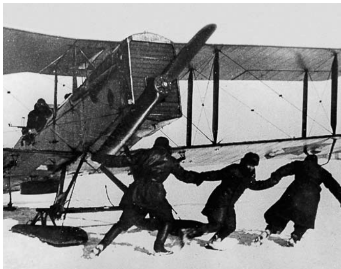
Запуск вручную 400-сильного двигателя самолета Р-1 был нелегким делом
