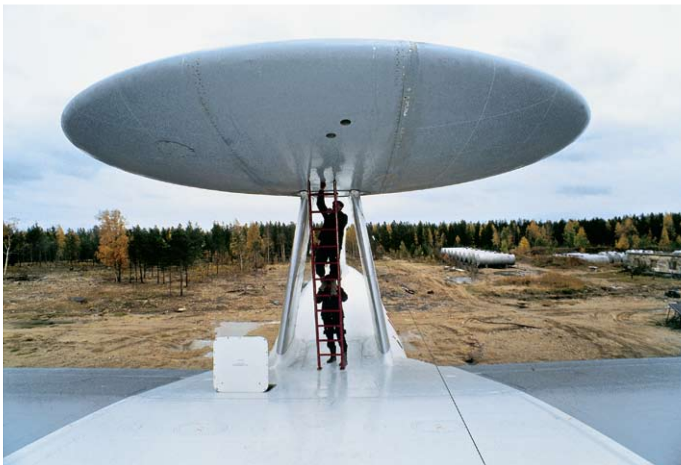
Антенна РЛС самолета дальнего радиолокационного обнаружения А-50
