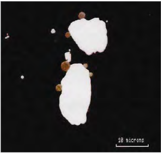
Рис. 19. Микрофотография поверхности черной лавы. Видны крупные включения окислов урана (белый цвет) и небольшие глобулы нержавеющей стали (серо-коричневый цвет)
