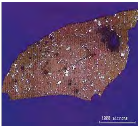
Рис. 26. Полированный препарат черной «лавы». Изображение получено в обратно-рассеянных электронах
