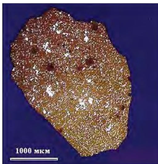
Рис. 25. Полированный препарат коричневой лавы. Изображение получено в обратно-рассеянных электронах
