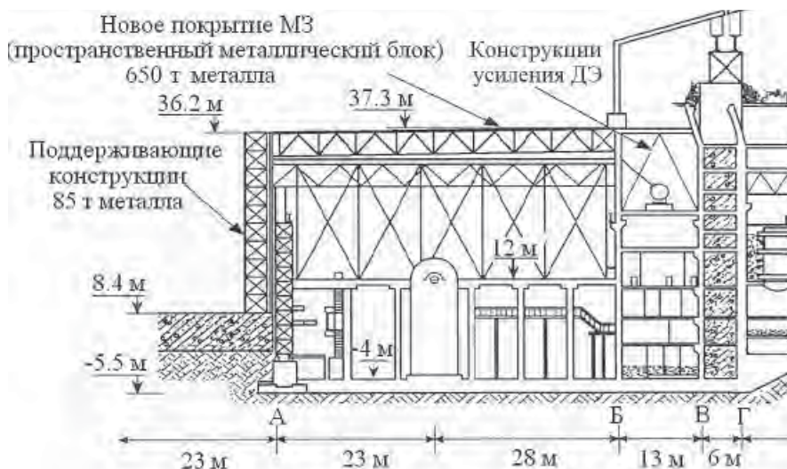
Рис. 6. Схема нового покрытия МЗ и поддерживающих конструкций
