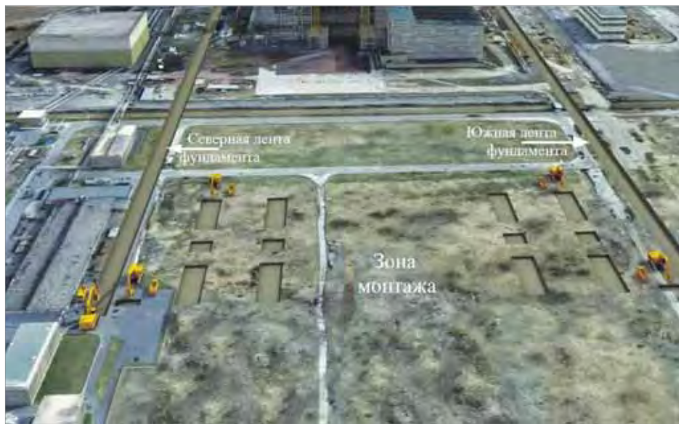
Рис. 7 Котлованы под фундаменты «Арки» (см. [12])
