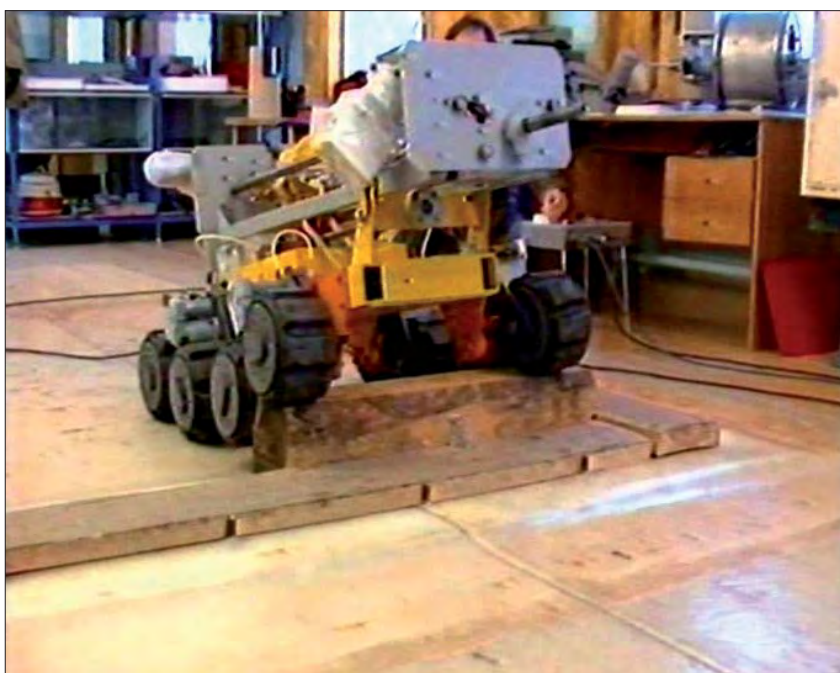
Рис. 9. Робот преодолевает препятствие
