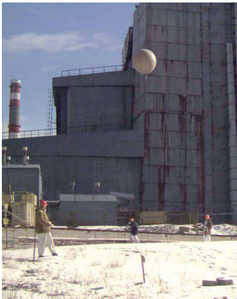
Рис. 15. Установка метеозонда в рабочее положение для измерения значения МЭД в намеченной точке
