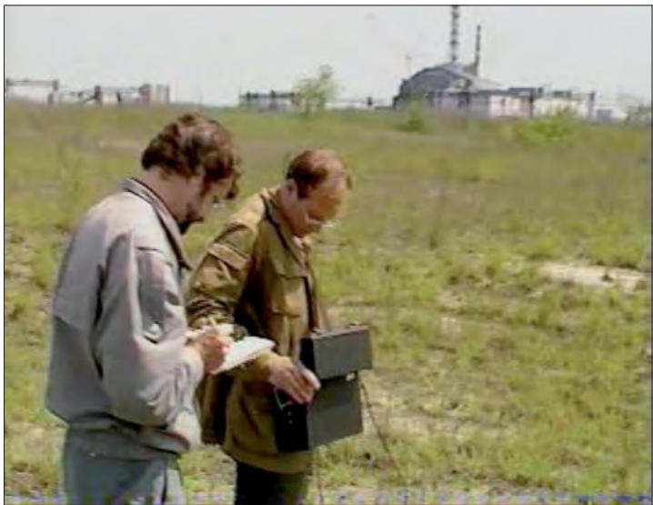
Рис. 14. Проведение измерений с коллимированным радиометром [23]
