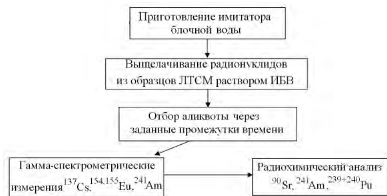
Рис. 19. Схема проведения экспериментов с имитатором блочной воды
