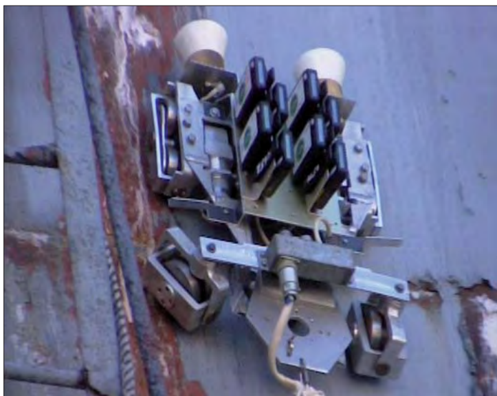
Рис. 43. Магнитоход на северной каскадной стене
