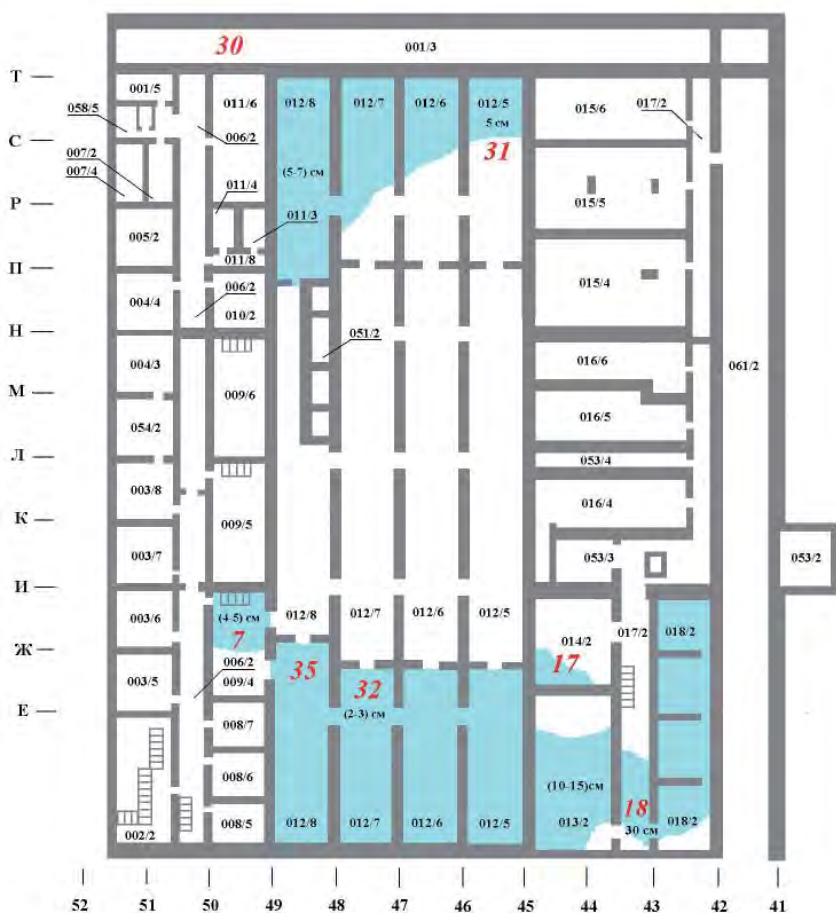
Рис. 10. Первый этаж бассейна-барбертера. Отмечено расположение скоплений воды, их глубина и точки отбора проб (красным цветом)
