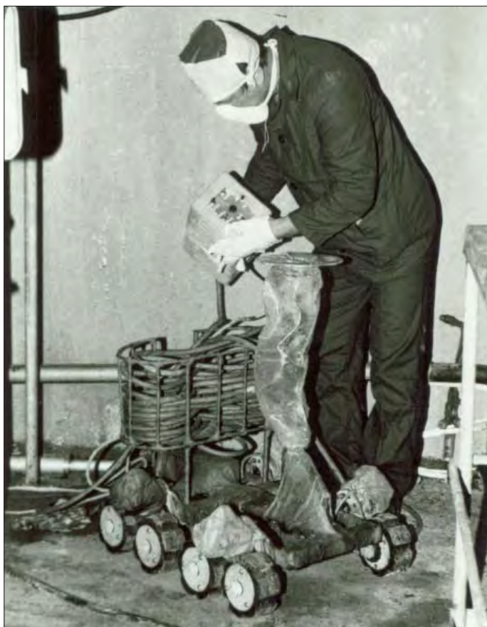
Рис. 13. Подготовка к работе ДУСА ТР-1 для проведения пылеподавления
