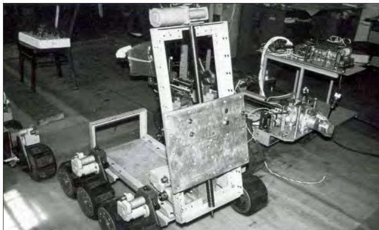
Рис. 26. Конструкция тележки и подвижной платформы ТР-7
