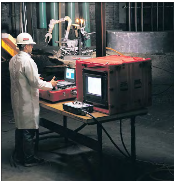
Рис. 46. Оператор за пультом робота «Пионер»
