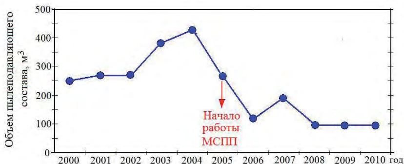
Рис. 8. Годовые объемы составов, поступавших в подкровельное пространство «Укрытия» в 2000–2010 гг. при проведении сеансов пылеподавления
