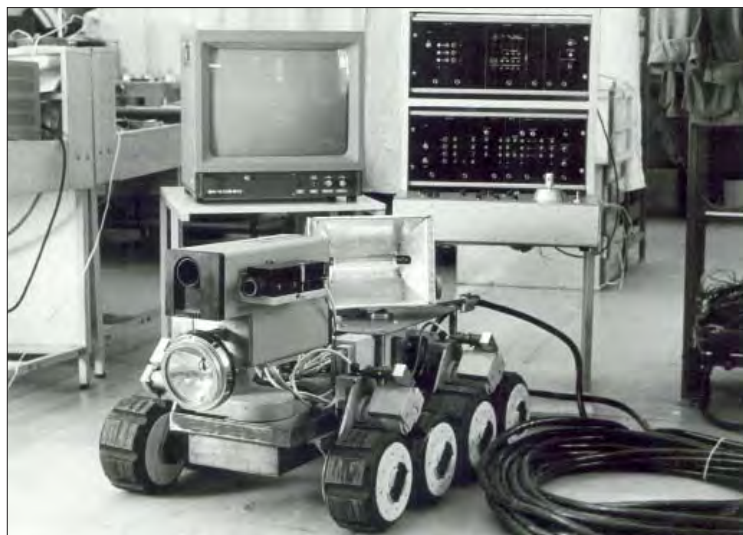
Рис. 31. ТР-10 в лаборатории. Сзади ДУСА – пульт управления
