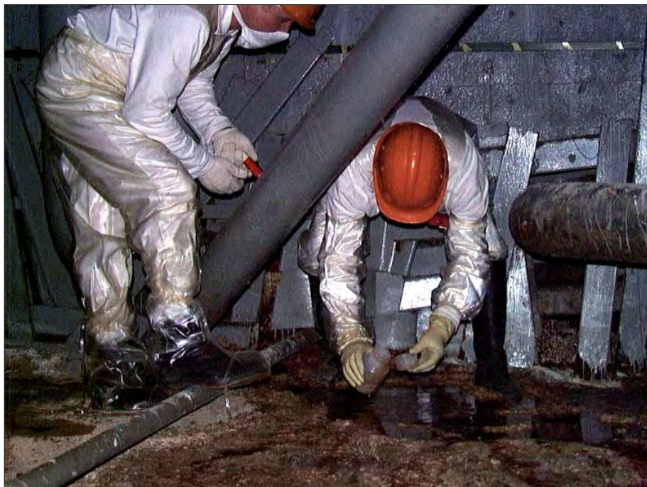
Рис. 16. Отбор пробы из скопления воды на объекте «Укрытие»
