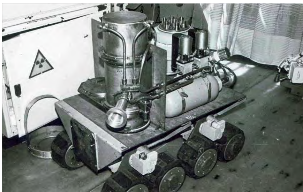
Рис. 15. ДУСА для очистки воздуха в помещениях «Укрытия» от пыли
