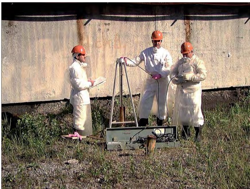
Рис. 24. Отбор проб грунтовой воды в локальной зоне «Укрытия»
