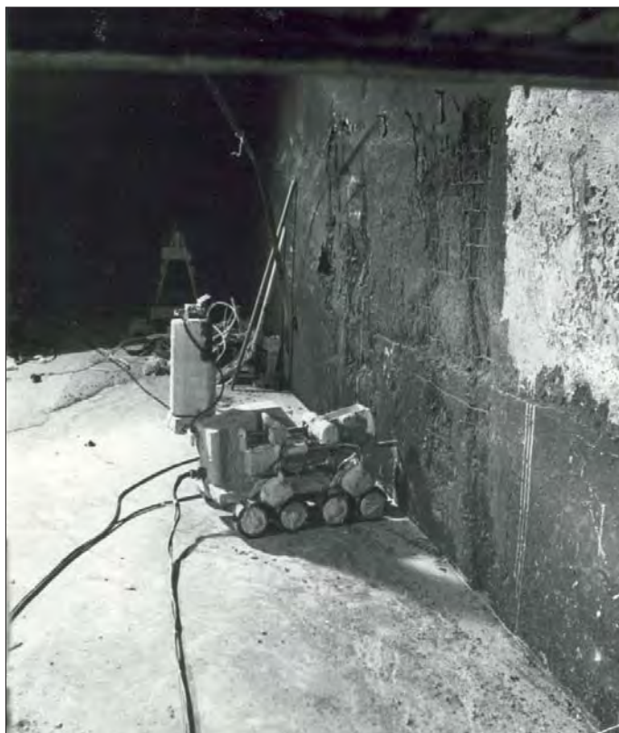
Рис. 18. ДУСА для отбора проб ТСМ и бетона — ТР-2 во время работы в пом. 308/2
