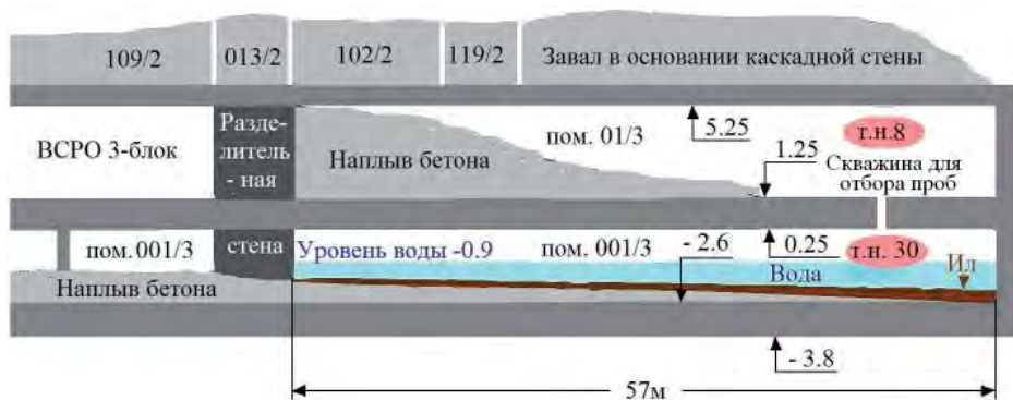
Рис. 22. Разрез помещений 001/3 и 01/3. Указаны строительные отметки. Вид с севера [23]
