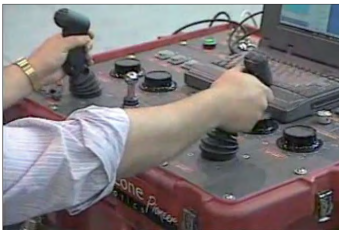
Рис. 47. Пульт управления роботом «Пионер»
