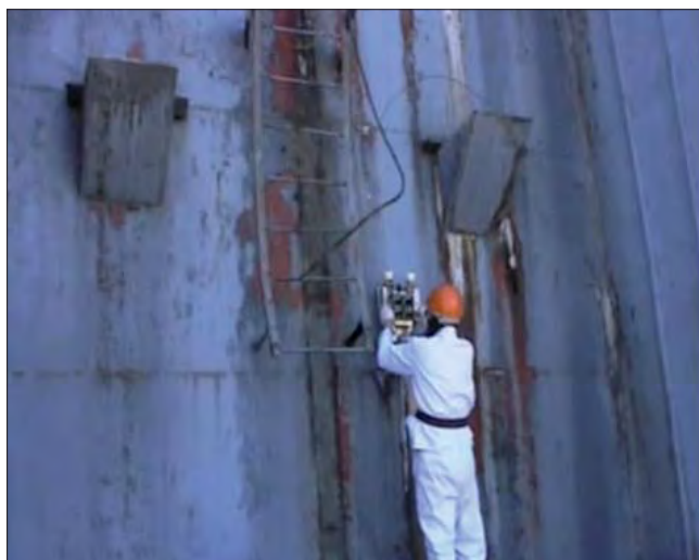
Рис. 42. Установка магнитохода на поверхность северной контрфорсной стены
