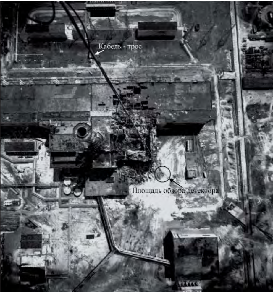
Рис. 5. Сканирование в локальной зоне (западная сторона). На снимке виден кабель-трос прибора. Кругом обозначена площадь обзора детектора [3]
