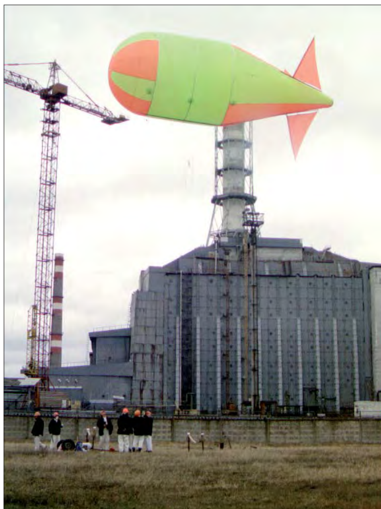
Рис. 14. Установка аэростата в рабочее положение для измерения значения МЭД в намеченной точке
