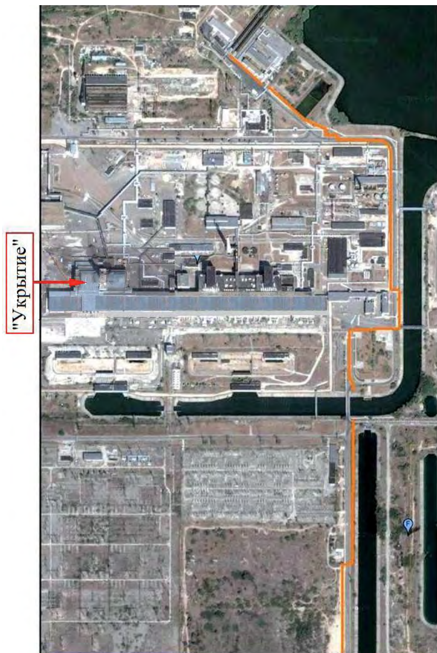
Рис. 22. Место расположения «стены в грунте» выделено оранжевым цветом (фото промплощадки ЧАЭС из Google Map) [21]
