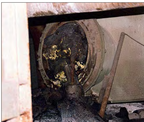
Рис. 1. Желтые пятна новообразований на потоках лавы в парораспределительном коридоре
