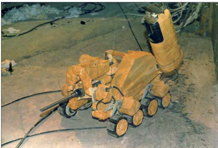
Рис. 7. Робот, сконструированный в КИ. Специальное покрытие предохраняет его внутренние детали от запыления
