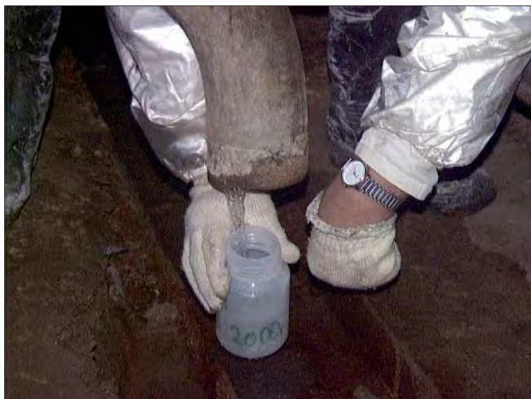
Рис. 17. Отбор пробы воды на объекте «Укрытие»
