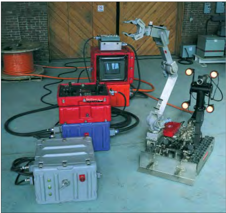
Рис. 45. Полный комплект аппаратуры робота «Пионер»
