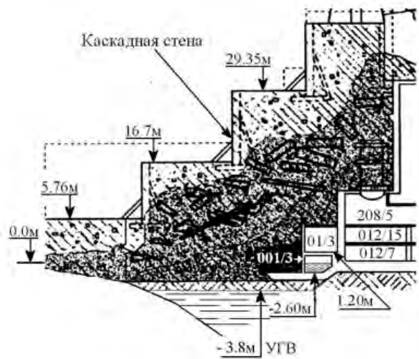
Рис. 12. Расположение пом. 001/3 ВСРО и скопление воды в нем. Указаны строительные отметки для каскадной стены и пом. 0.01/3
