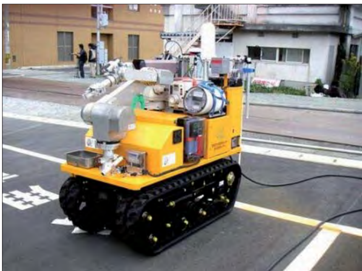
Рис. 2. Робот, созданный специалистами региональных университетов Чика и Тохоку (Япония), специально для работ внутри разрушенных реакторов АЭС «Фукусима-1»
