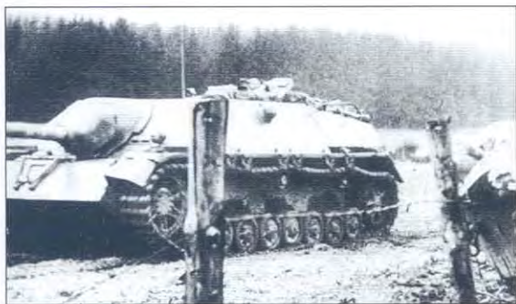
Pz.IV/70(V), оснащенный мощным 75-мм длинноствольным орудием (длиной 70 калибров), был достаточно дешевым и одновременно очень эффективным противотанковым средством. Арденны, 1-й тд СС, декабрь 1944 года (АВЛ).
