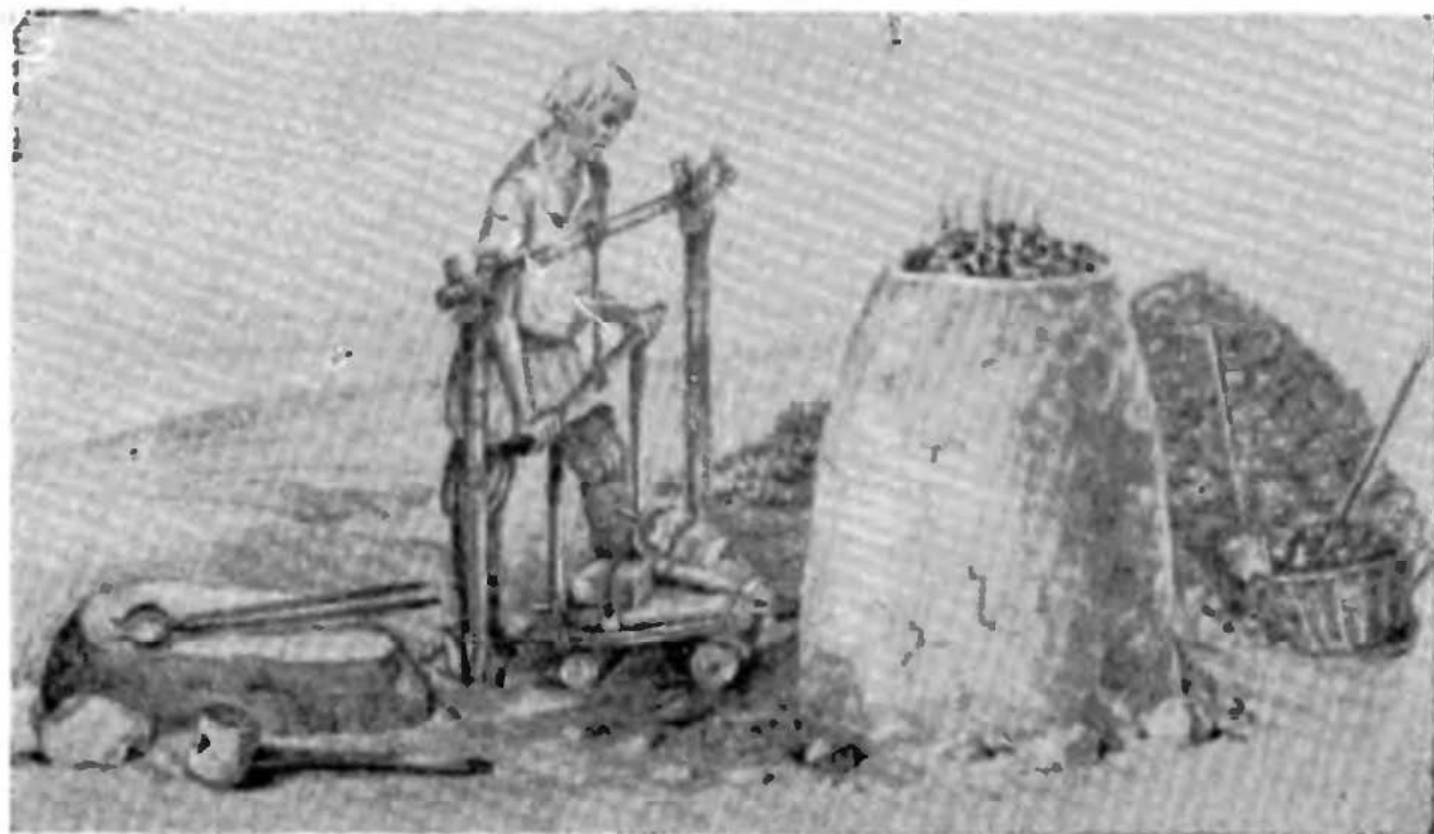
Р и с. 2. Сыродутный горн древней Руси. Реконструкция Б. А. Колчина.
