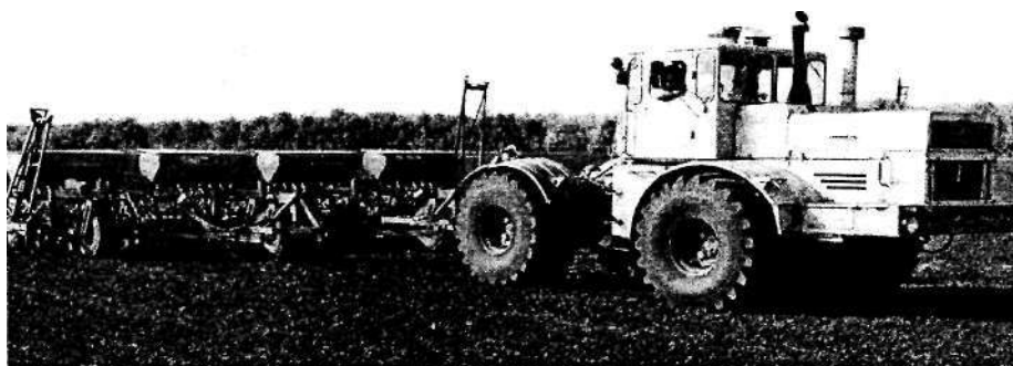
Рисунок 79 - Комбинированный посевной агрегат АУП-18,05
