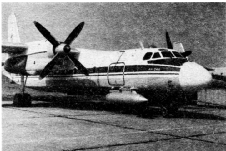
Ан-24Б российских ВВС. По бокам фюзеляжа расположены фильтр-гондолы для отбора проб воздуха
