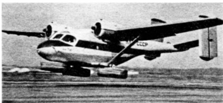
Ан-14А с шасси на воздушной подушке
