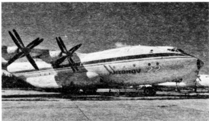
Ан-22, доработанный для транспортировки консолей крыла самолета Ан-124
