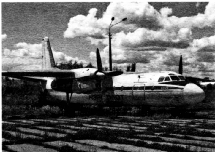
Ан-24Б с большим грузовым люком в правом борту фюзеляжа
