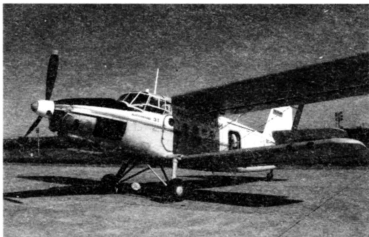
Ан-3Т с турбовинтовым двигателем. Авиация МЧС
