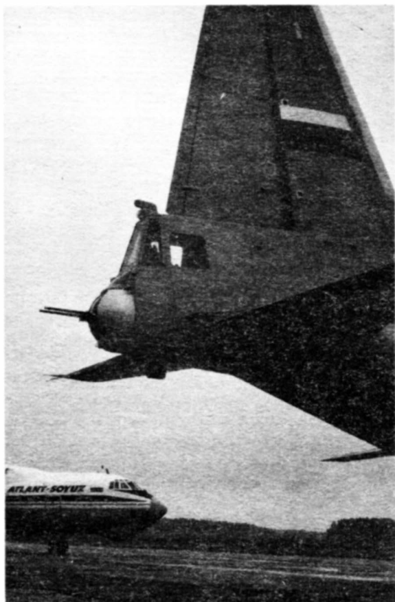
Для обороны от самолетов противника на Ан-12 предусмотрена артиллерийская установка с двумя пушками АМ-23
