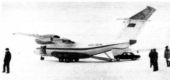
Первый опытный экземпляр военно-транспортного самолета укороченного взлета и посадки Ан-72
