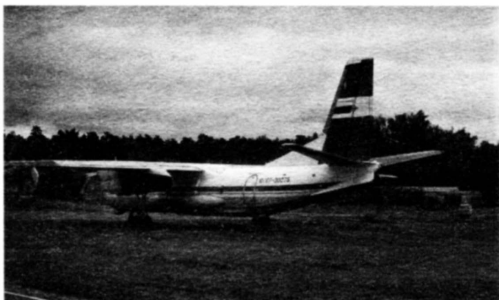
Ан-30Д с накладными топливными баками
