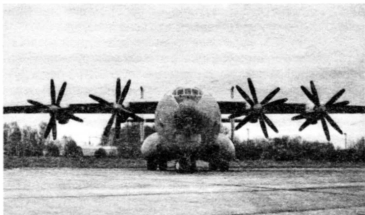
С какой стороны на «Антей» ни посмотри, его размеры и соосные воздушные винты подчеркивают грандиозность машины
