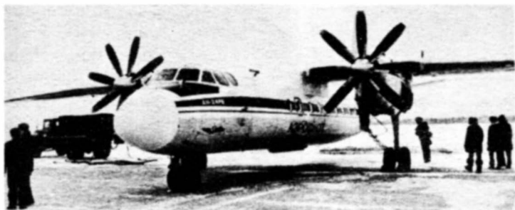
Самолет-лаборатория Ан-24РВ с восьмилопастными воздушными винтами
