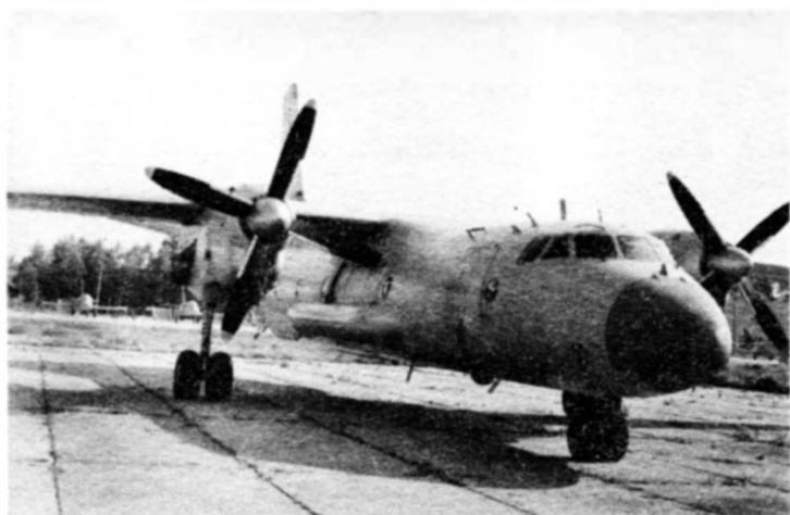
Ан-26Д с накладными топливными баками
