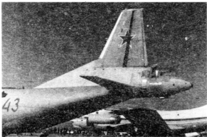
Летающая лаборатория ЛИИ имени М.М. Громова. В кормовой части самолета на месте стрелковой установки смонтирована поворотная кабина для испытаний катапультных кресел
