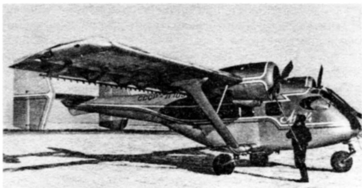
На первых машинах Ан-14 для прохода в салон служила дверь в носовой части фюзеляжа
