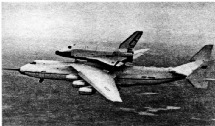
Транспортировка орбитального корабля «Буран» самолетом Ан-225
