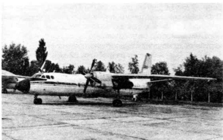
Ан-24 ранних серий без вспомогательного двигателя РУ19-300
