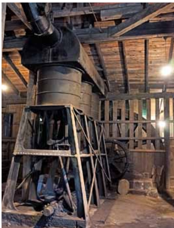
Цилиндрические мехи с приводом от водяного колеса (доменная печь в Энгельсберге (Ängelsberg), Швеция)
