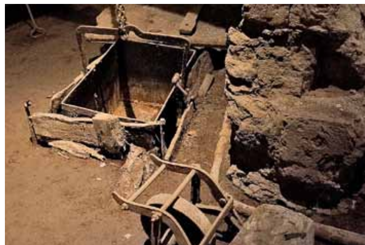
Оборудование для изготовления литого шлакового блока, литейный двор доменной печи завода Энгельсберг, Швеция.
