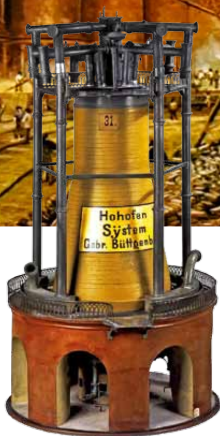
Доменная печь конструкции Бютгенбаха, завод Neusser-Hütte, 1870-е гг. (трубы, поддерживающие колошниковую площадку, одновременно служат для отвода газов)
