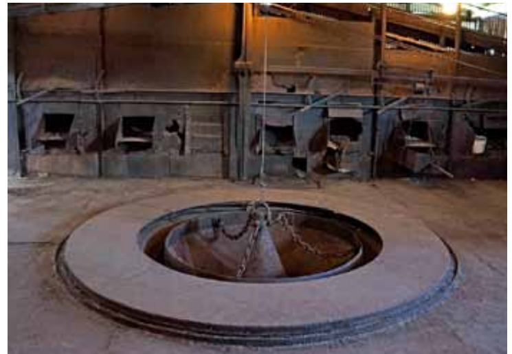
Колошниковая площадка с устройствами для взвешивания и засыпки шихтовых материалов и воронкой Парри (доменная печь завода RIDDARHYTTAN, Швеция)
