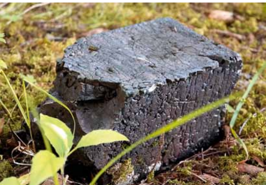
Железистый шлак кричного передела чугуна в железо, отлитый в блоки, и заросший шлаковый отвал. Железодельательный завод Гравендал, Швеция
