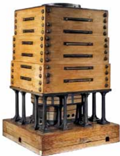
Доменная печь Рашета. Верхне-Туринский завод, 1870 г. Модель. Экспонат Горного музея СПбГИ
