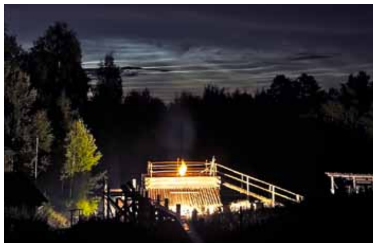
Загрузка шихты и плавка в печи с открытым колошником. Реплика средневековой доменной печи XIV века (Экспериментально-археологическая площадка Nya Lapphyttan, Швеция)
