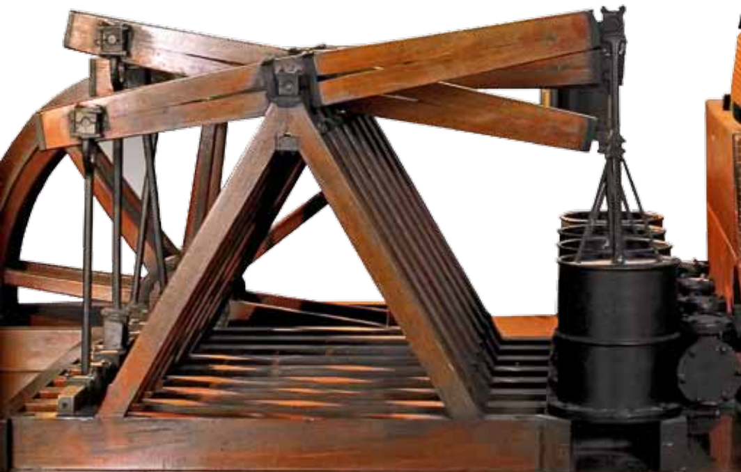
Цилиндрические мехи с водяным приводом и доменная печь, построенная по шотландскому образцу. Александровский завод, Петрозаводск, 1787 г. Модель. Экспонат Горного музея СПбГИ
