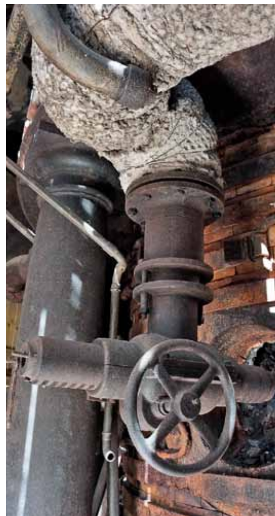
НЕОХЛАЖДАЕМЫЕ АМБРАЗУРА и ФУРМА НА ДРЕВЕСНОУГОЛЬНОЙ печи (завод HOGFÖRS, Швеция)
