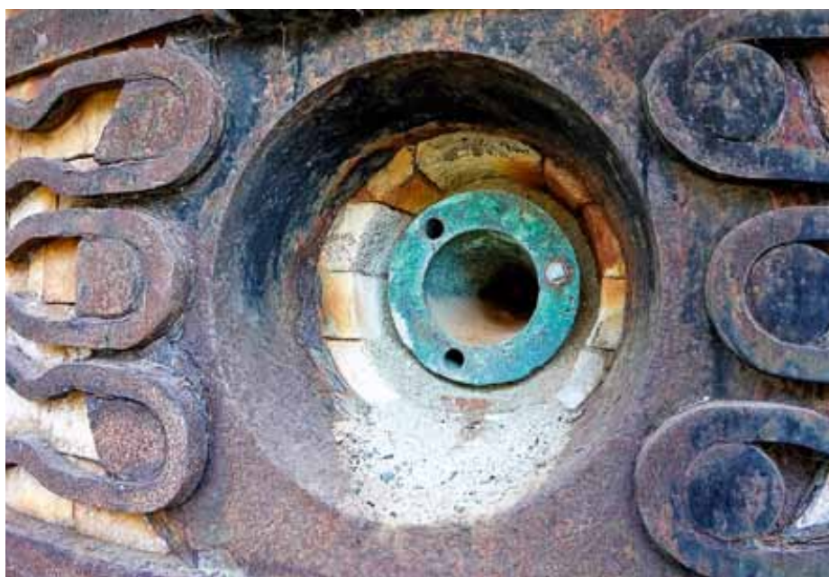
Водоохлаждае- мая АМБРАЗУРА и ФУРМЕННЫЙ ПРИ- БОР для подачи дутья (ФУРМА ОТСУТСТВУЕТ) (ДОМЕННАЯ ПЕЧЬ ЗАВОДА RIDDARHYTTAN, ШВЕЦИЯ)
