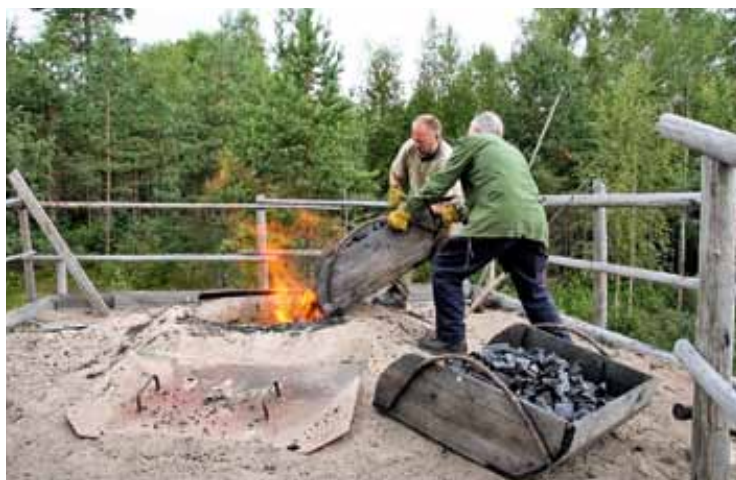
Загрузка шихты и плавка в печи с открытым колошником. Реплика средневековой доменной печи XIV века (Экспериментально-археологическая площадка Nya Lapphyttan, Швеция)
