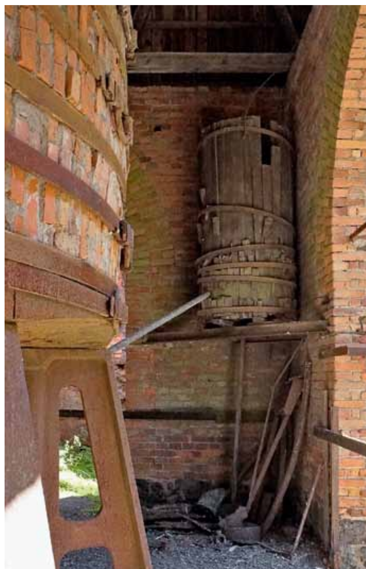
Остатки емкости для воды (слева) и трубопровода (справа) для охлаждения фурменных амбразур. Завод Кленсхюттан (Klenshyttan, Швеция)
