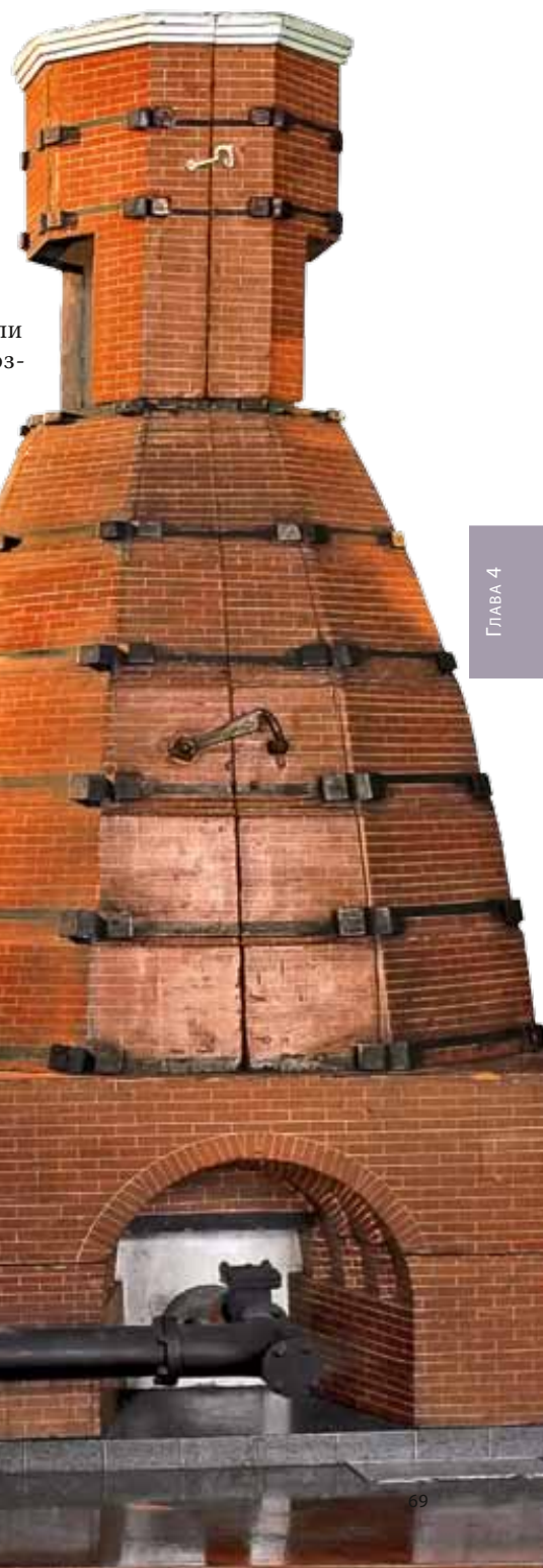
Цилиндрические мехи с водяным приводом и доменная печь, построенная по шотландскому образцу. Александровский завод, Петрозаводск, 1787 г. Модель. Экспонат Горного музея СПбГИ
