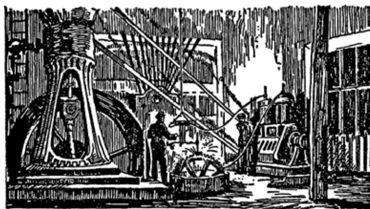
ДИНАМО-ЭЛЕКТРИЧЕСКАЯ МАШИНА
