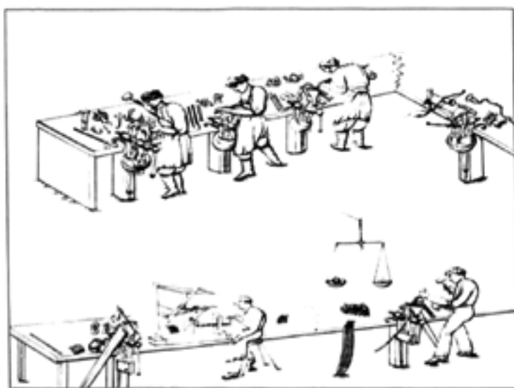
Отделка эфесов и изготовление проволоки. Справа — отливка эфесов
