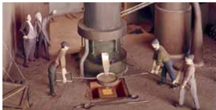
снизить интенсивность реакций не представлялось возможным, Бессемер сконструировал новый агрегат со специальной камерой-уловителем в верхней части. Эта система была запатентована в мае 1856 г. вместе с изложницей для отливки металла, дно которой представляло собой поршень гидравлического пресса, который выталкивал слиток после его застывания.
