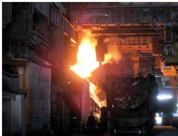
этой проблемы было предложено сливать чугун в специально устроенный коллектор (позднее он стал называться миксером). Коллектор, как правило, имел цилиндрическую форму, располагался на роликах и мог поворачиваться вокруг продольной оси гидравлическим устройством.
