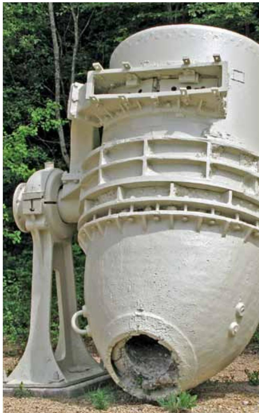
воздух, поступающий в конвертер через сопла в днище. Эта камера обеспечивала равномерность подачи воздуха и делалась съёмной.
