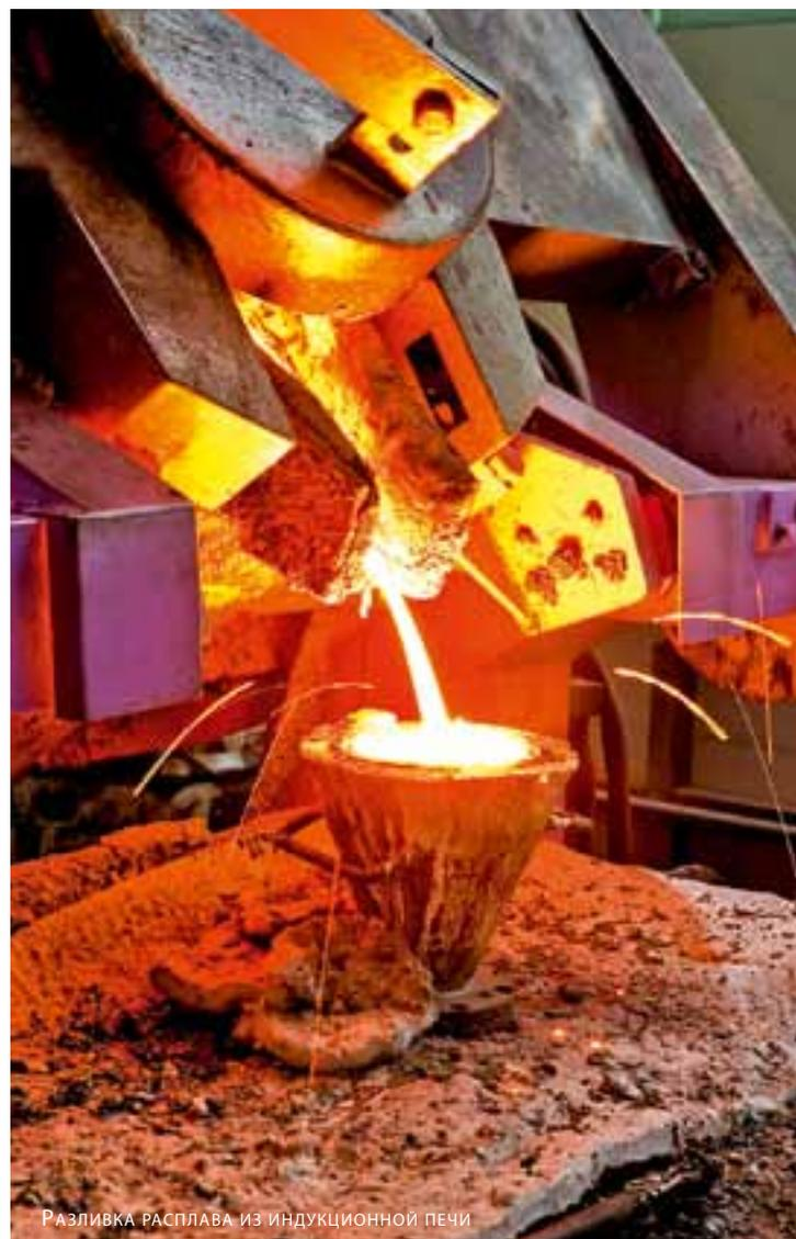
Разливка расплава из индукционной печи
