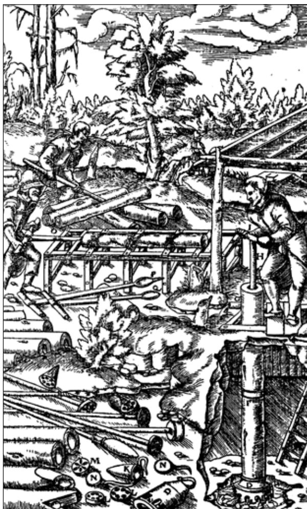
СВЕРЛЕНИЕ ТРУБ И ПОДЪЁМ ВОДЫ (из труда Г. Агриколы «12 КНИГ О МЕТАЛЛАХ»)
