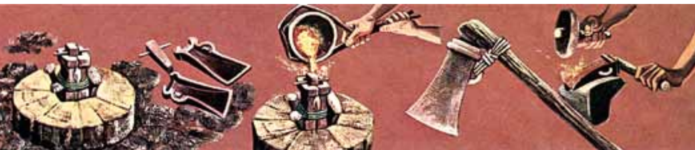
Изготовление бронзового топора методом литья в разъемную форму
