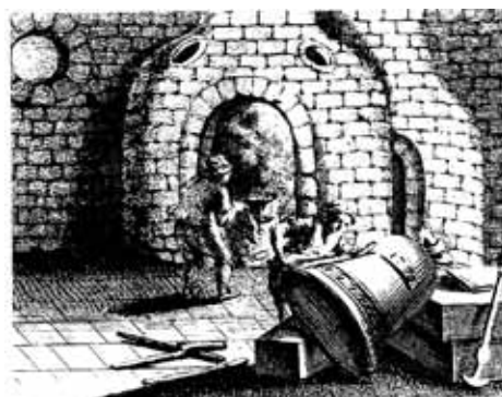
Чистовая обработка колокола: А – очистка поверхности (гравюра из книги «Арена природы и искусств», Вена, конец XVII в.); Б – чеканка (гравюра К. Люкена, 1698 г.)
