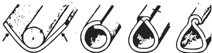
ВАРИАНТЫ ВЫПОЛНЕНИЯ ПРОДОЛЬНОГО ШВА ДРЕВНЕРИМСКИХ СВИНЦОВЫХ ТРУБ
