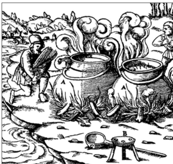
ПРОЦЕСС ВЫПАРИВАНИЯ СОЛИ А – котлы; В – треножник; С – черпак; (из труда Г. Агриколы, «12 КНИГ О МЕТАЛЛАХ»)
