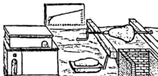
Отливка колоколов по Теофилу: изготовление стержня шаблона (В. Бирингуччо «Пиротехния»); изготовление литейной формы (руководство Теобальда) (а – шпиндель; б – изготовление и сушка стержня; в – изготовление воскового слоя)
