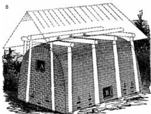
СТАЦИОНАРНЫЕ ПЕЧИ для выжигания древес- ного угля: А, Б – имитирующие стоячую кучу, В – имитирующие лежащую кучу, Г – с нижним разжи- ганием и улавлива- нием продуктов перегонки
