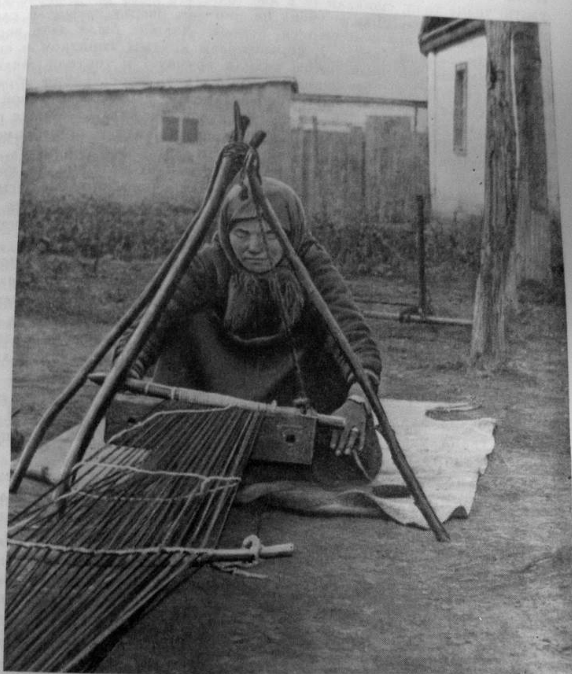
Р и с. 1. Тканье шерстяной армячины на узконавойном станке
