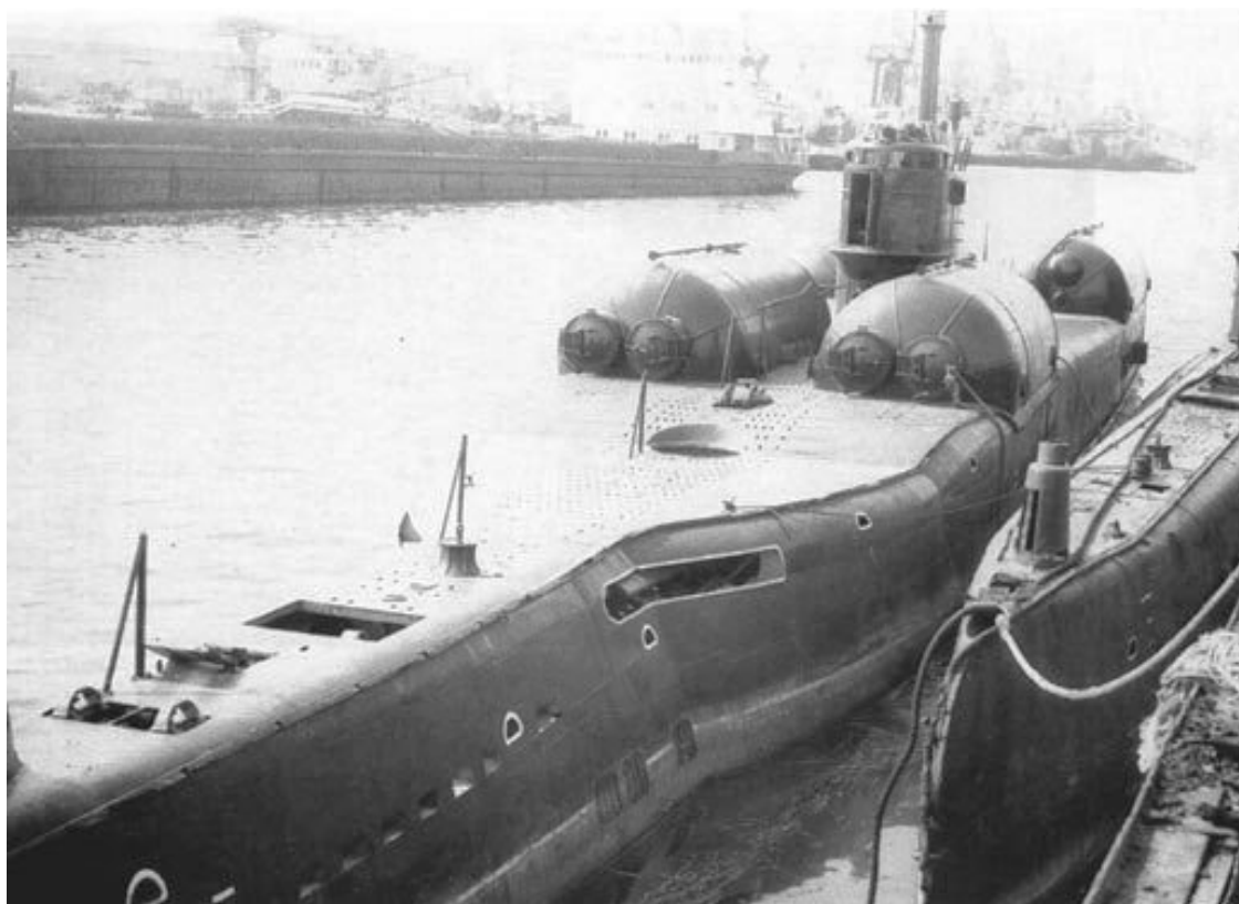
С-273 в Ленинграде в ожидании разделки на металл. Хорошо видны цистерны для жидких кислорода и водорода (Н. Г. Масловатый)
