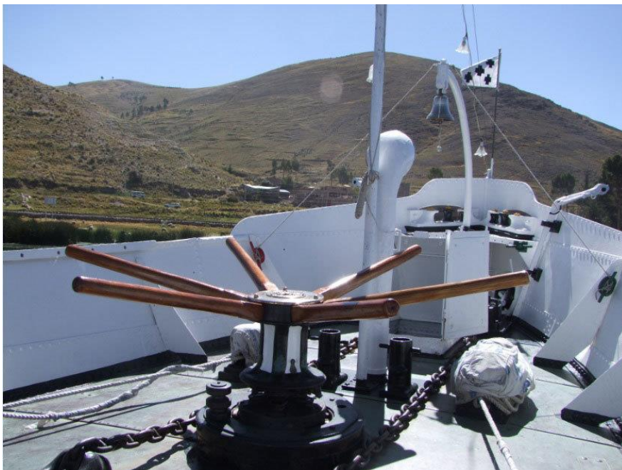
Якорно-швартовый шпиль «Явари» (фото The Yavari Project)
