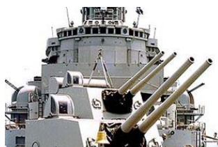
Носовые 152-мм орудия и 40-мм артиллерийские установки “Breda-Bofors” “Almirante Grau”
