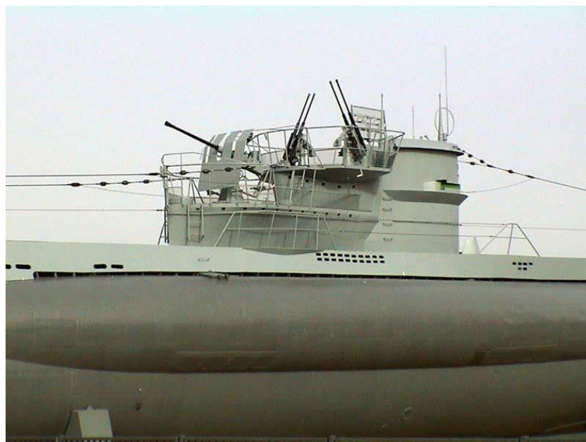
«Винтергартен» U995 с зенитными 20-мм (2 х2) и 37-мм орудиями (из архива автора)
