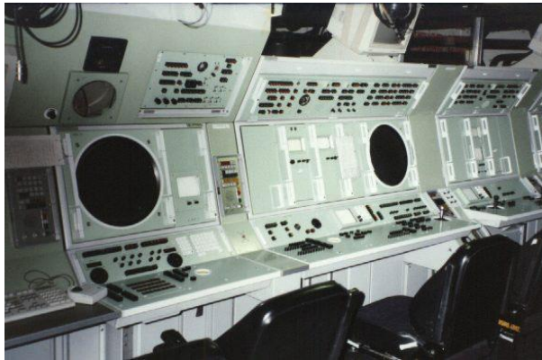
Пульт боевой информационно-управляющей системой SEWACO
