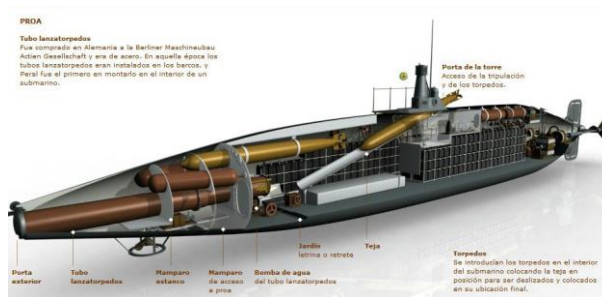
Схема устройства лодки “Peral” (фото El Pais)
