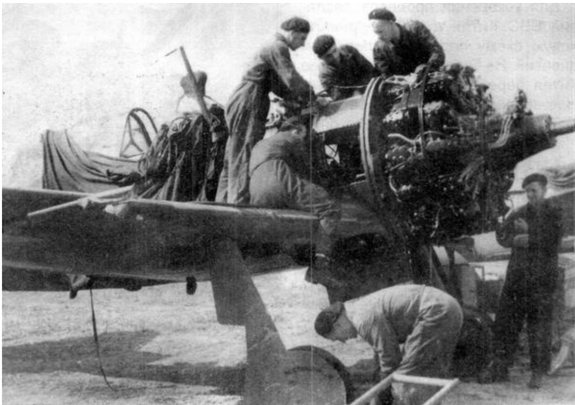
Техническое обслуживание Ла-9; двигатель полностью раскапотирован.
