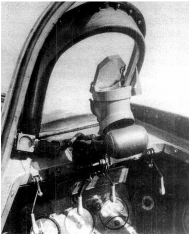
Прицел ПБП-1Б за бронестеклом козырька пилотской кабины.
