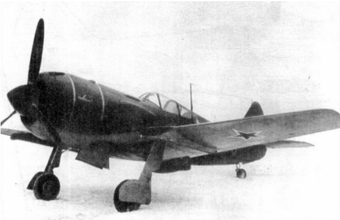
Ла-9РД со снятыми ПуВРД Д-13.
