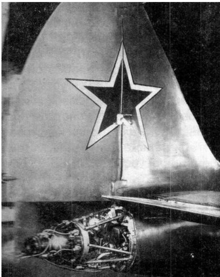
Жидкостный ракетный двигатель РД-1ХЗ (без обтекателя) в хвостовой части перехватчика «120».
