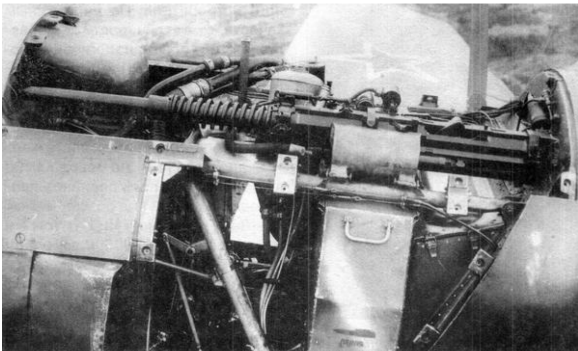
Вооружение Ла-9В состояло из одной пушки НС-23 по левому борту.
