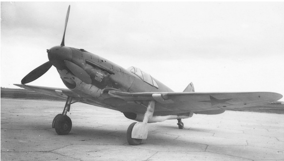
Истребитель ЛаГГ-3 с мотором М-105ПФ, май 1942 г.
