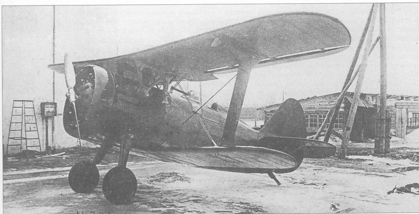
Опытный истребитель И-15, заводской №33907 (ЦКБ-3№7), оборудованный классическим бипланым центропланом и коллектором выхлопных газов. Заводские испытания, 1935 г.
