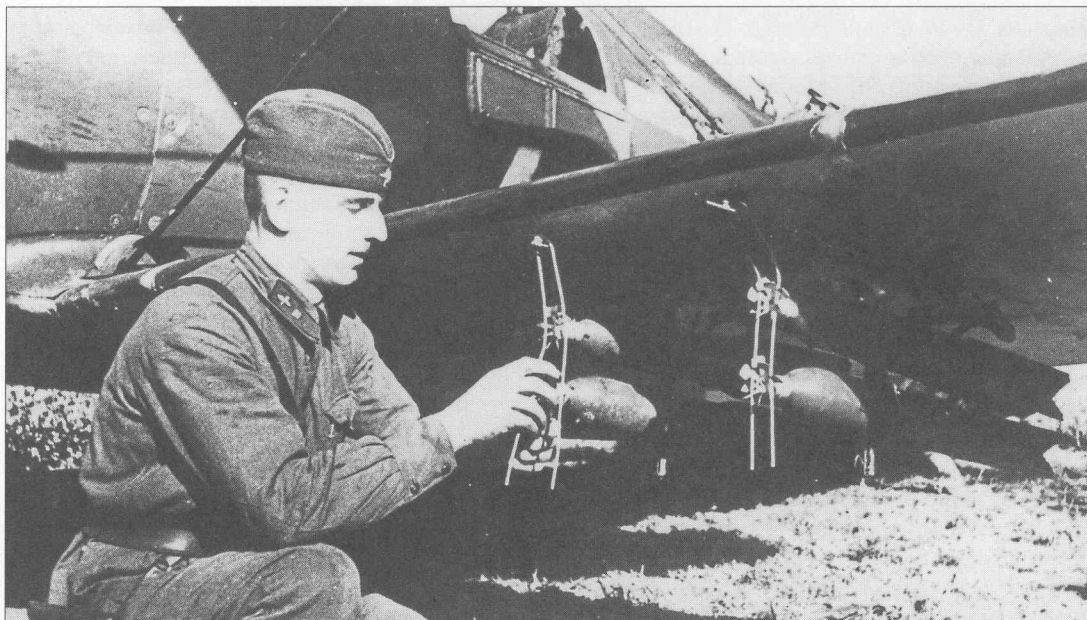
Подвеска мелких бомб «двухярусным» методом на бомбодержателях ДЕР-31 под нижним крылом И-15бис
