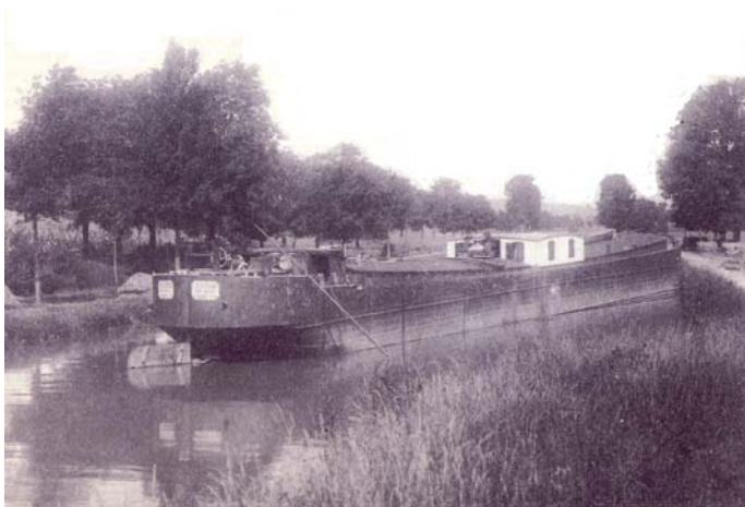
Рис. 60. Железная барка «Petit Pierre» с дизель-мотором
