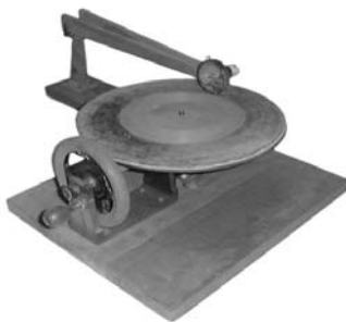
Граммофон Э. Берлинера, серийная модель с ручным приводом 1888 г.
