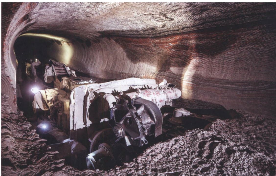
Проходка выработок околоствольного двора
