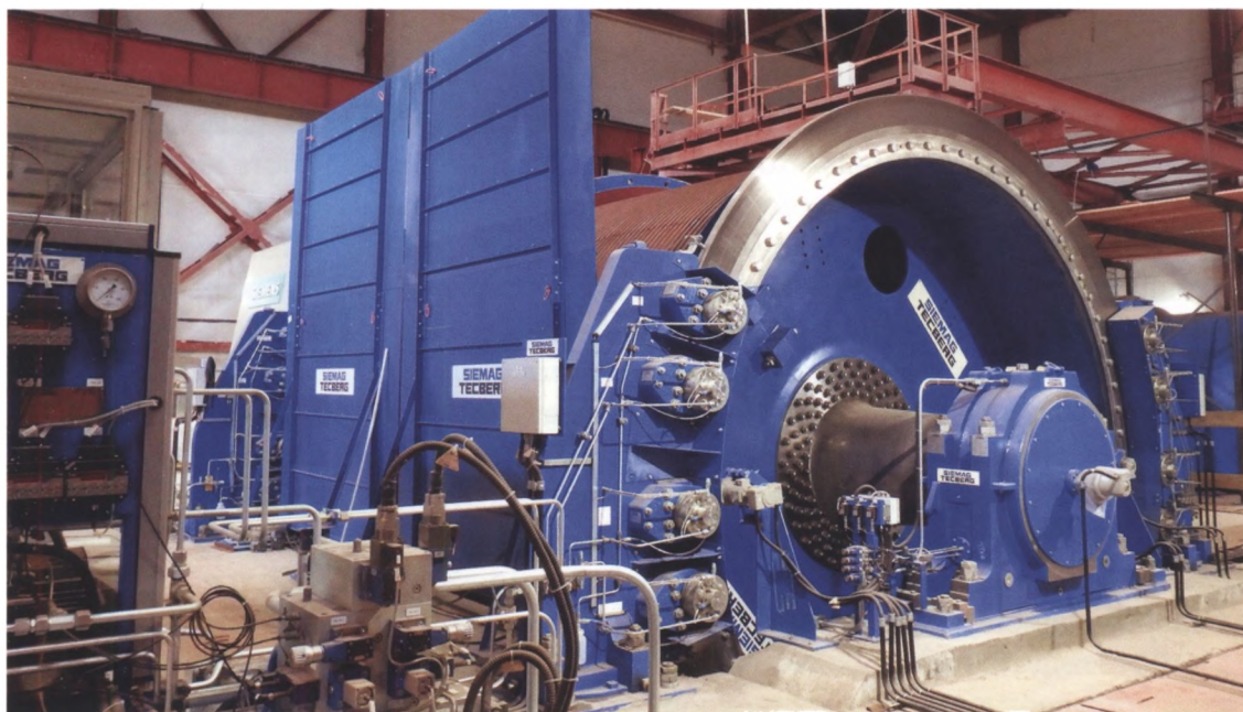
Монтаж шахтной подъемной машины на Усть-Яйвинском руднике
