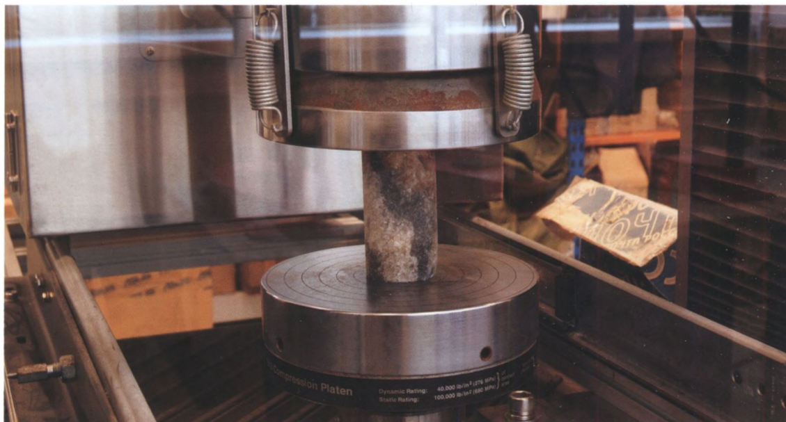
Испытание на одноосное сжатие образца каменной соли НИЛ Геомеханики
