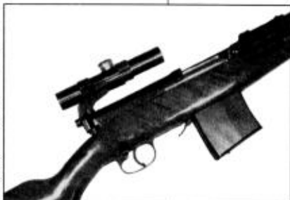
Оптический прицел ПУ на винтовке СВТ. Самозарядка Токарева так и не получила признания в среде фронтовых снайперов во время войны
