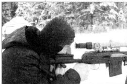
Стрельба из снайперской винтовки СВД с установленным на ней автоматическим прицелом ПСП-1
