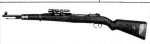
Германская снайперская винтовка системы Маузера (K98) с оптическим прицелом полуторакратного увеличения
