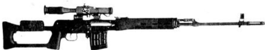
Современный вид винтовки СВД с пластмассовым прикладом
