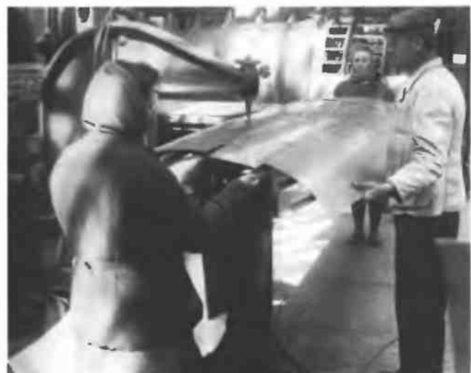
Рис. 5.7. Пневмоклейка панели. 1949 г.
