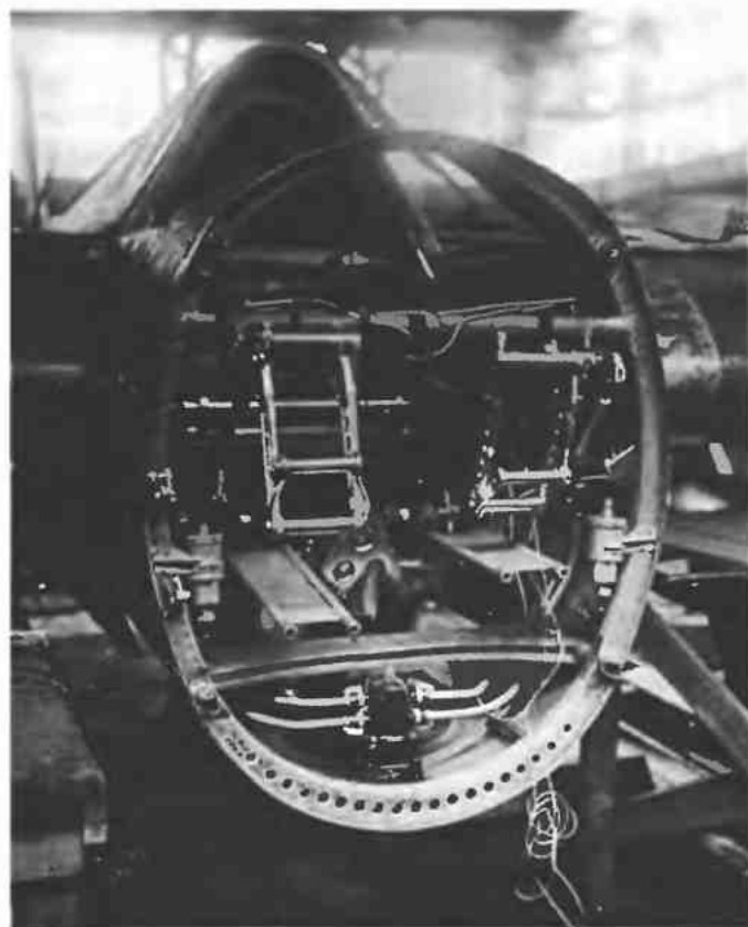
Рис. 3.4. Сборка фюзеляжей бомбардировщика СБ на 22-м заводе
