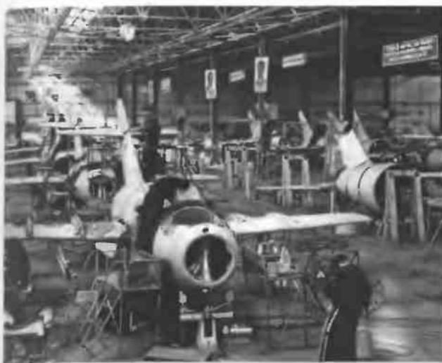
Рис. 5.9. Поточная сборка МиГ-15 на заводе № 1.
