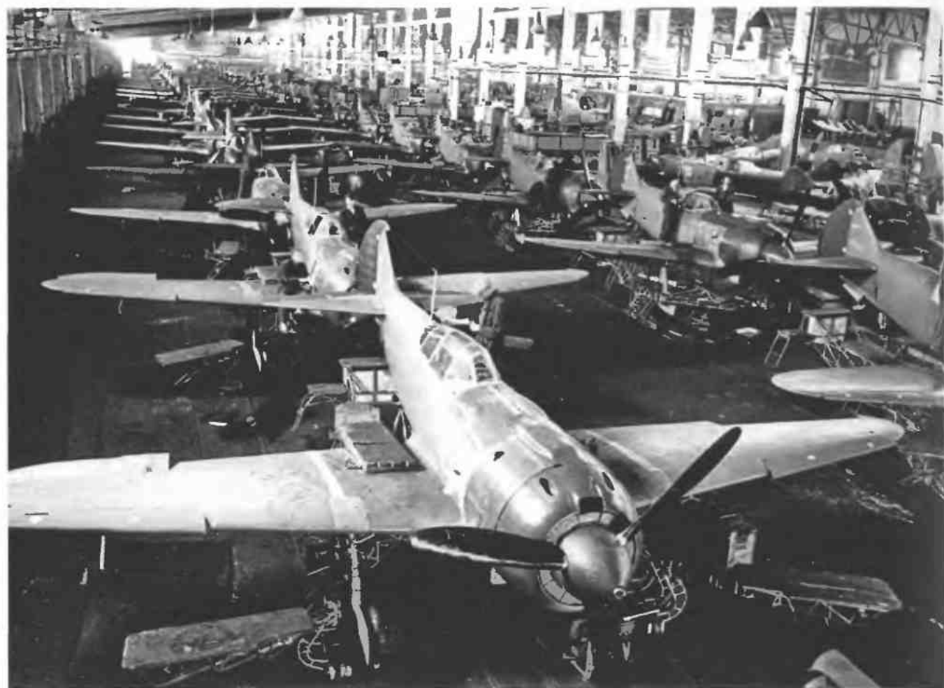
Рис. 4.6. Сборочные линии самолетов Ла-5 на заводе № 21
