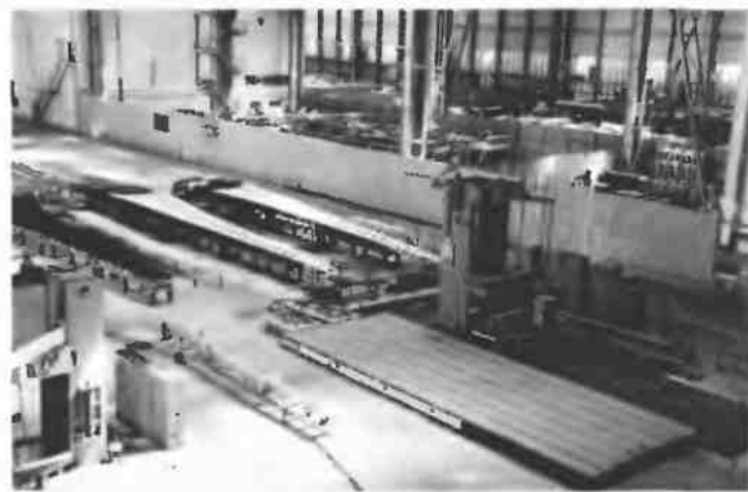
Рис. 6.13. Станок с ЧПУ для фрезерования длинномерных панелей (Казанское авиапроизводственное объединение)
