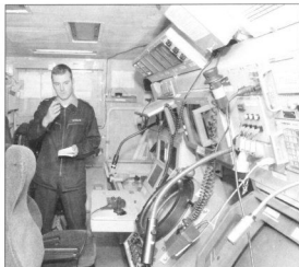
Пост контроля за подводной обстановкой и управления противоминными аппаратами
