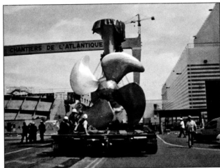
⚙ Четырехлопастный гребной винт фиксированного шага, изготовленный из нержавеющей стали
