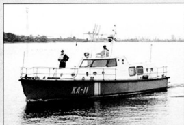
Патрульный катер KA11 (переоборудован из служебно-разъездного катера проекта 371бис "Адмиралтеес")
