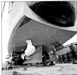
⚙ Движительная система QM2 в сборе
