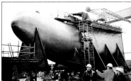
Бульб лайнера – гигантское сооружение длиной около 30 м и массой 450 т
