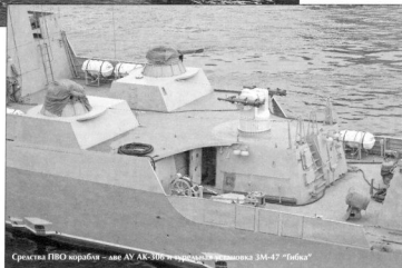
Средства ПВО корабля – две УВ АК-306 и ракетно-артиллерийская установка 3М-47 «Тибика»
