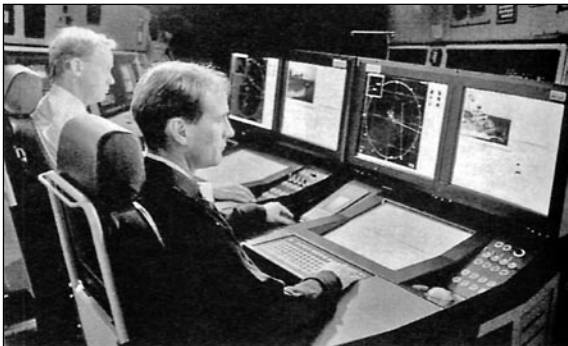
Макет пульта управления СУО 9LV Mk.3E корвета «Visby»
