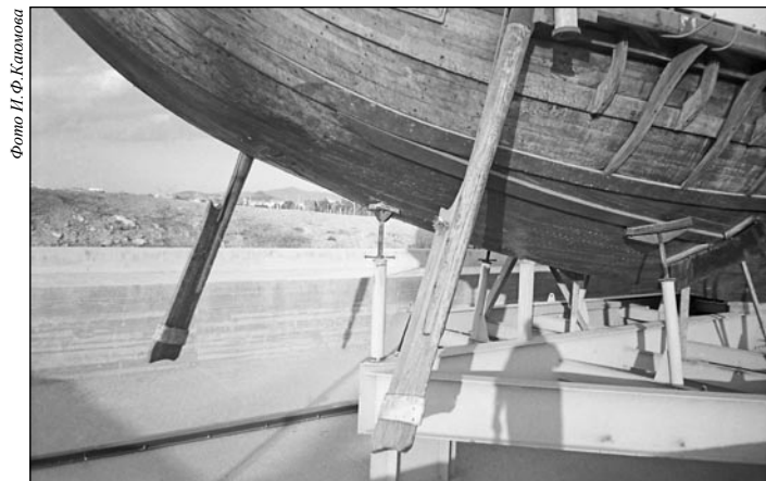
Кормовая часть триеры «Олимпия»: видны оба рулевых весла (на снимке слева) и левый борт носовой части (снимок справа)
