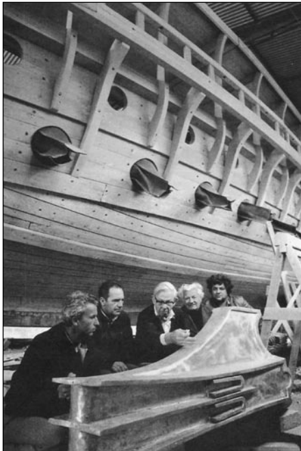
Корпус «Олимпии» довольно гладкий, имеет плавные обводы и обеспечивает небольшую осадку корабля. Отверстия для весел самого нижнего яруса, расположенные на высоте 40 см от ватерлинии, защищены кожаными манжетами. Уключины весел самого верхнего ряда вставляли в выносные кронштейны. На переднем плане автор проекта (в середине) и его коллеги обсуждают форму тарана.
