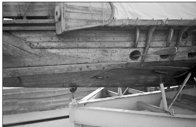
Кормовая часть триеры «Олимпия»: видны оба рулевых весла (на снимке слева) и левый борт носовой части (снимок справа)
