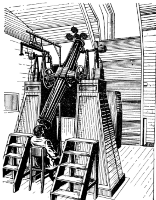
Рис. 3. Большой пассажный инструмент Пулковской обсерватории.
