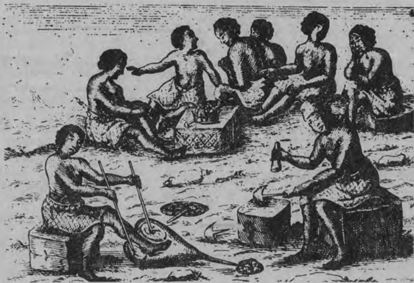
Африканские методы плавки железа (старинная гравюра)
