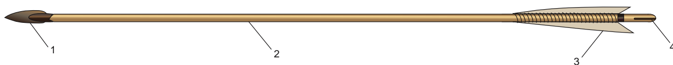
■ Дальность полета стрелы, выпущенной из английского лука, составляла от 165 до 228 м. На рисунке: 1 — наконечник; 2 — древко; 3 — оперение; 4 — зарубка
