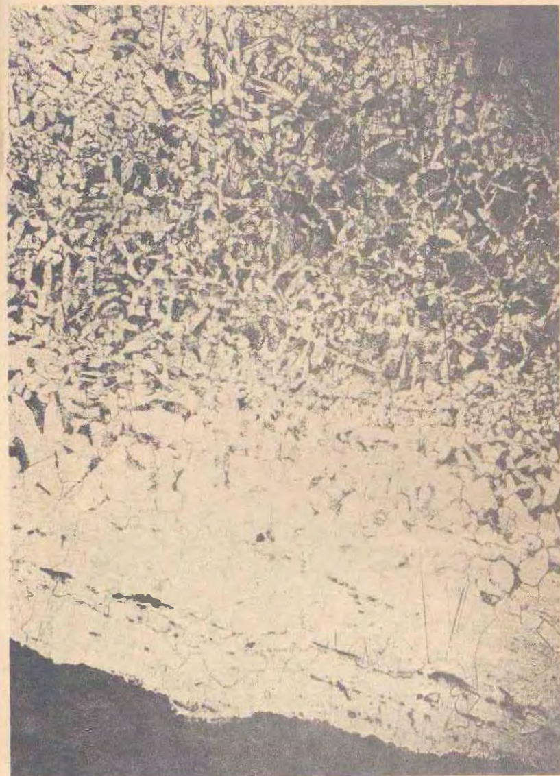
Рис. 54. Микроструктура отожженной стали. Ал. 215, ув. 50
