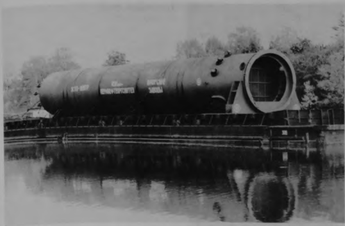
Транспортировка реактора гидрокрекинга для ОАО «ЛУКОЙЛ-Пермнефтеоргсинтез». 1996 г.
