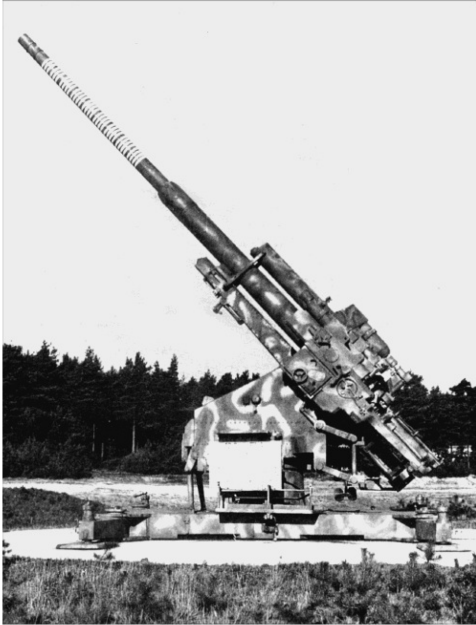
12,8-см зенитное орудие Flak 40, установленное на платформе
