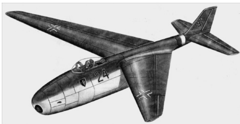
Проект немецкого «народного истребителя» P209.02 фирмы «Блом и Фосс». В конструкции применено крыло обратной стреловидности. Взлетный вес 4094 кг. Максимальная скорость 988 км/ч. Вооружение: две 30-мм пушки МК-108
