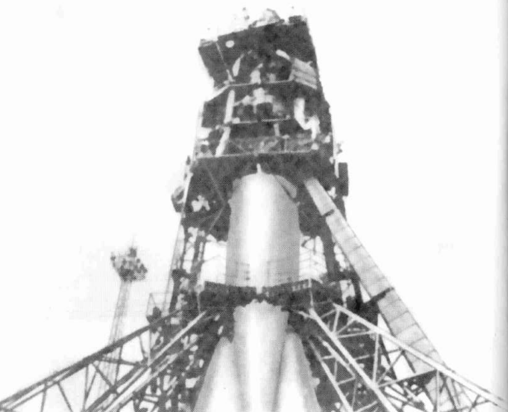
Над ракетой сомкнулись фермы обслуживания, на которых проводятся последние предстартовые работы.
