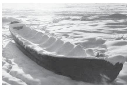
Лодка, долблённая из ствола тополя. Экимчан, берег Селемджи, 1969 г. Фото из архива В. Лецика
