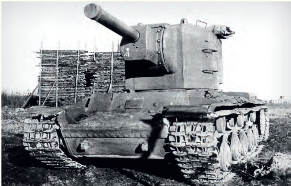
Испытания танка КВ-2 с первым образцом «пониженной» башни. Сентябрь 1940 года
