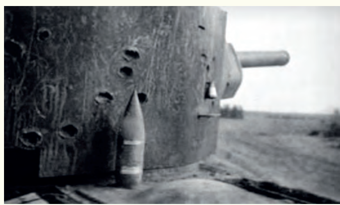
Следы от попадания снарядов на башне КВ-2
