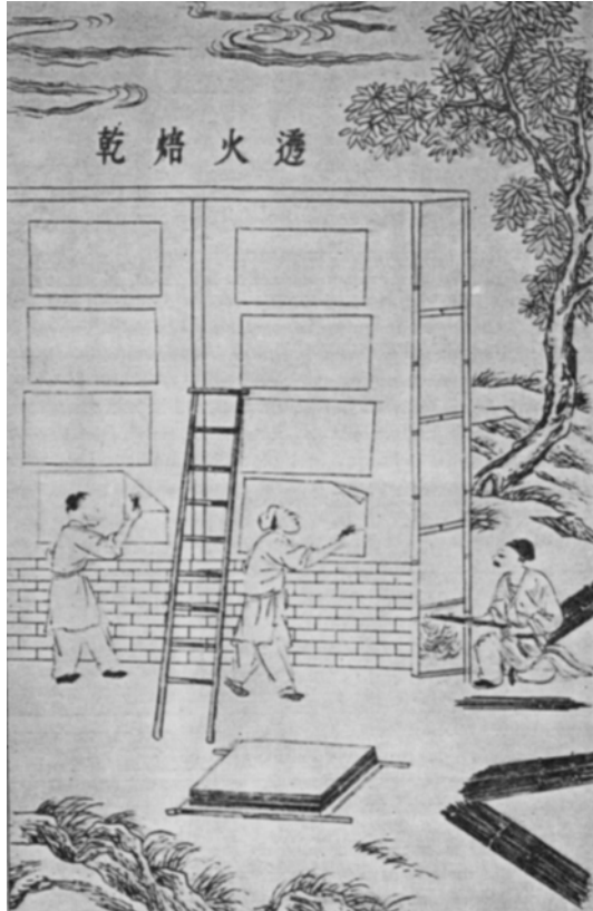
Просушка бумаги [Hunter D. Papermaking. Pleiades Books, 1947. С. 192, рис. 168; с. 82, рис. 46]
