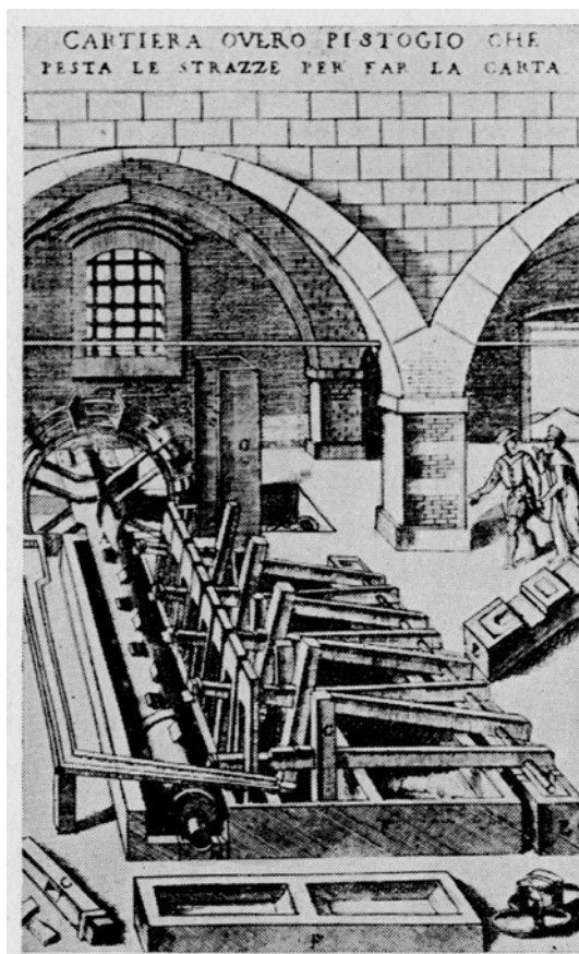
Толчея с водяным приводом [Hunter D. Papermaking. The history and technique of an ancient craft. London: Pleiades Books, 1947. С. 158, рис. 135]
