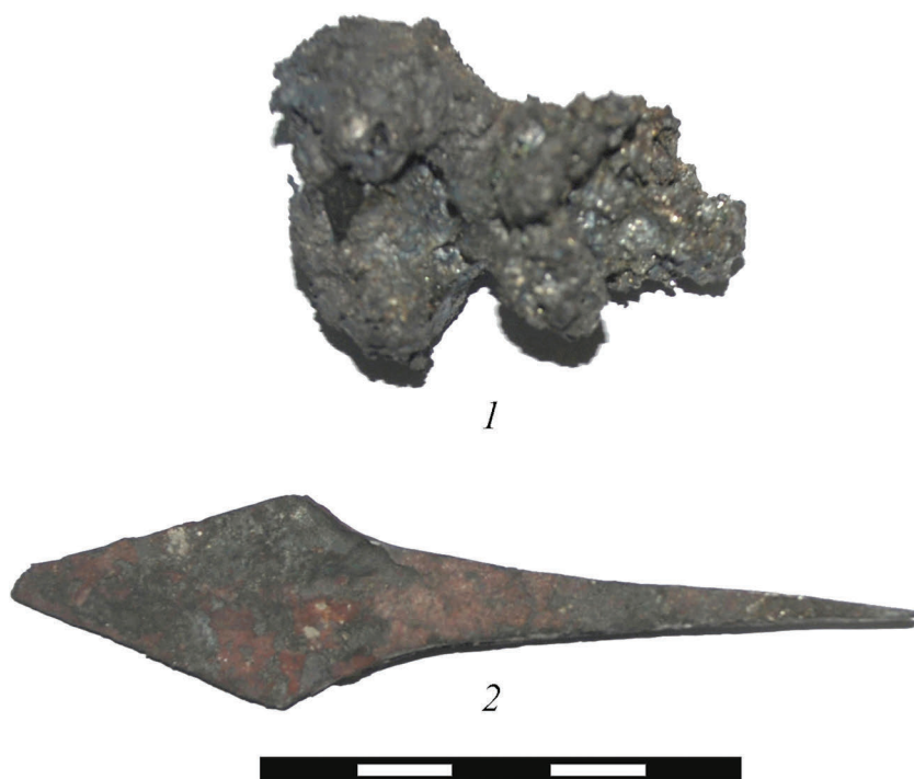
Рис. 7. Кричное железо, полученное в ходе эксперимента (1), и откованный из него наконечник стрелы (2).
