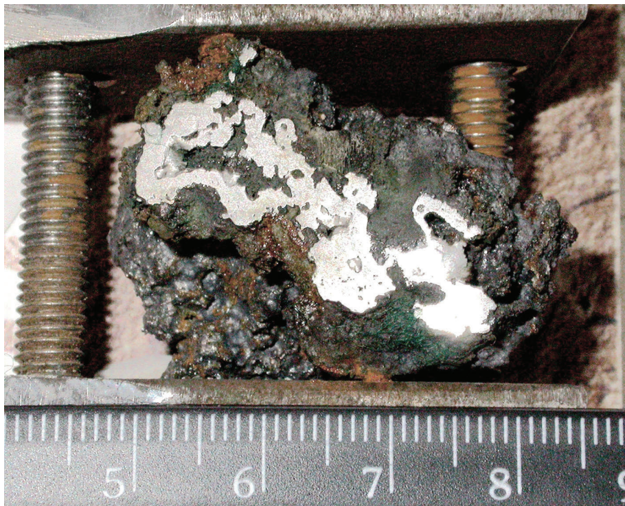
Рис. 6. Кричное железо, полученное экспериментальным способом из руды Истьянского рудопроявления.
