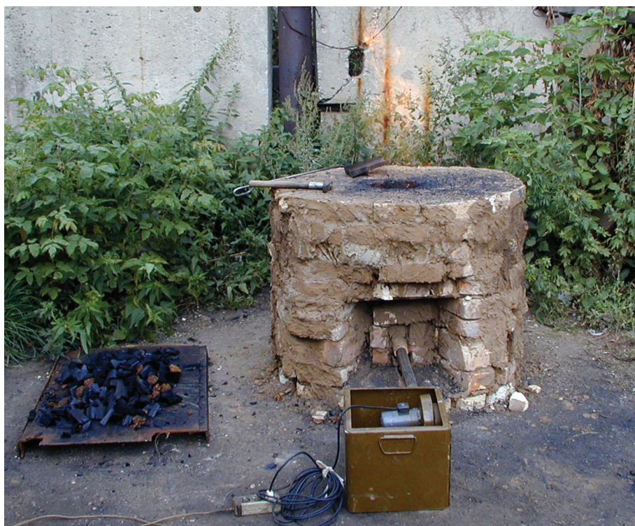
Рис. 5. Экспериментальная модель сыродутного горна.
