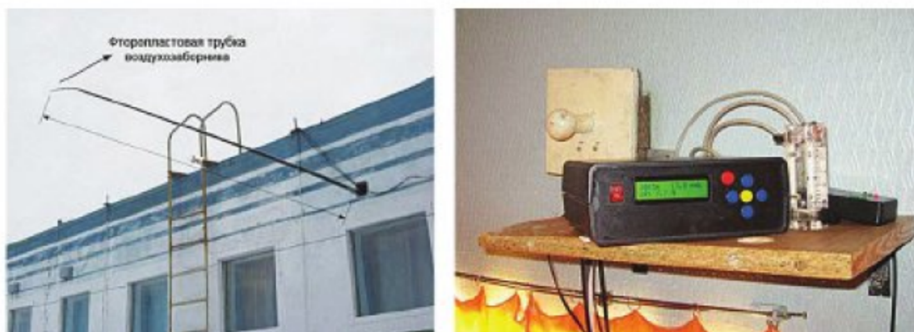
Рис. 2.5. Малогабаритный ППС измеритель концентрации приземного озона на полевой базе РАЭ «Молодежная»
