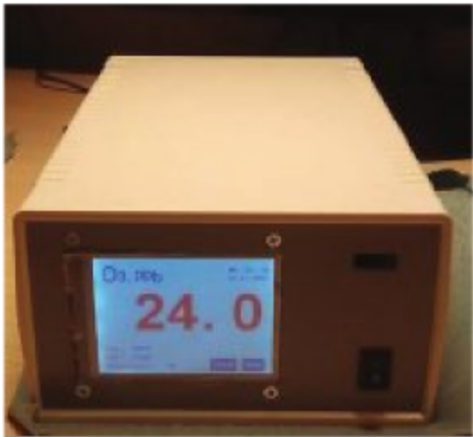
Рис. 2.8. Внешний вид нового прибора для измерения концентраций приземного озона Fig. 2.8. Original instrument for measuring the surface ozone concentrations
