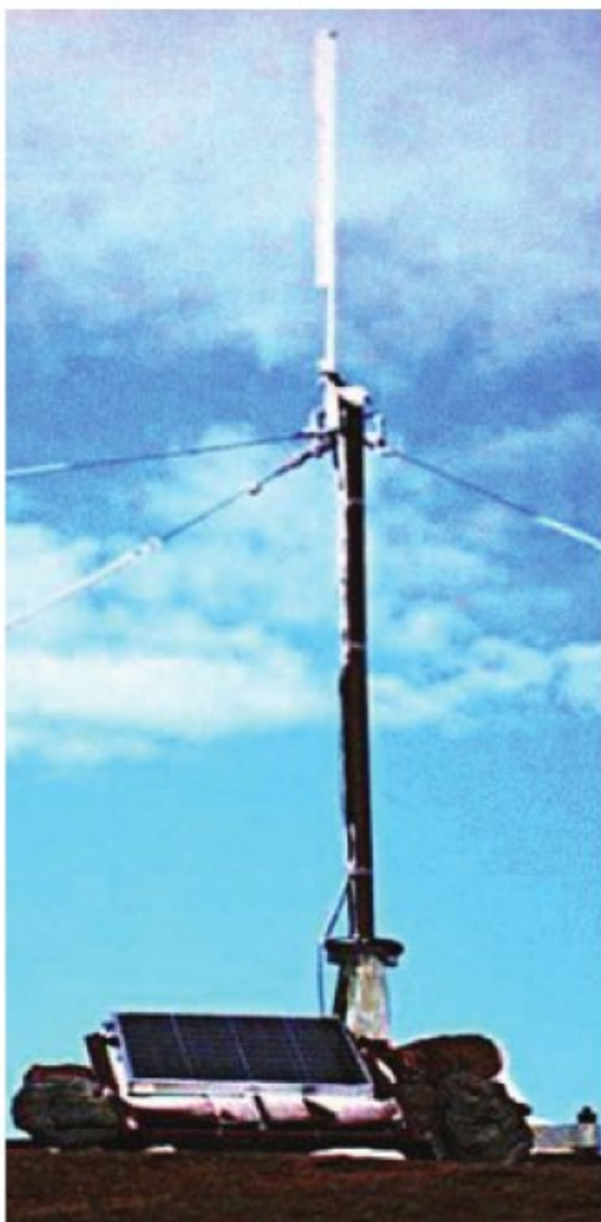
Рис. 1.15. УКВ-ретранслятор Fig. 1.15. VHF re-transmitter
