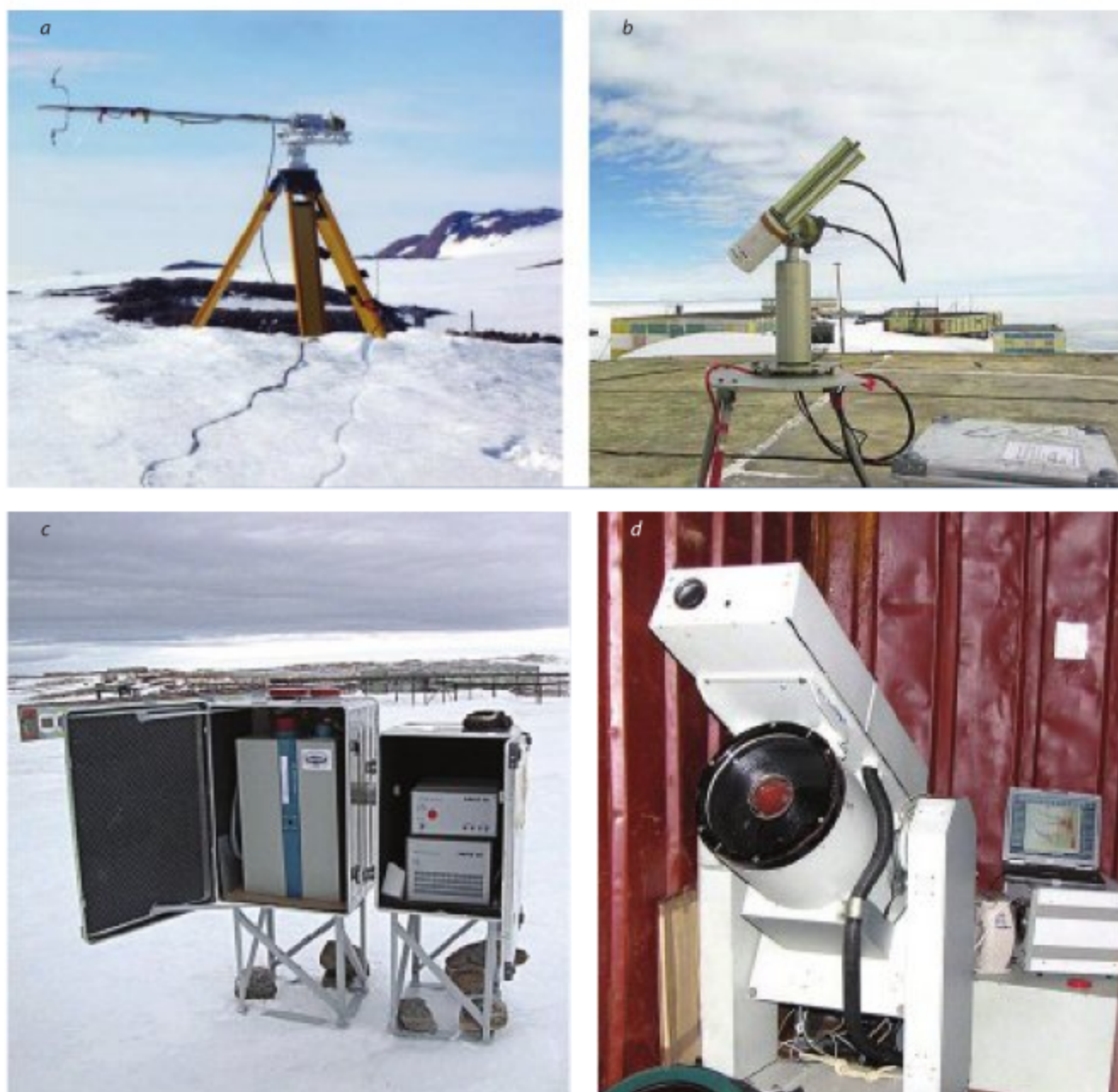
Рис. 2.9. Аппаратура для измерения характеристик аэрозоля и подстилающей поверхности: а – спектральный альбедометр; б – многоволновый сканирующий солнечный радиометр; в – двухволновой лидар; д – многоволновой рамановский лидар
