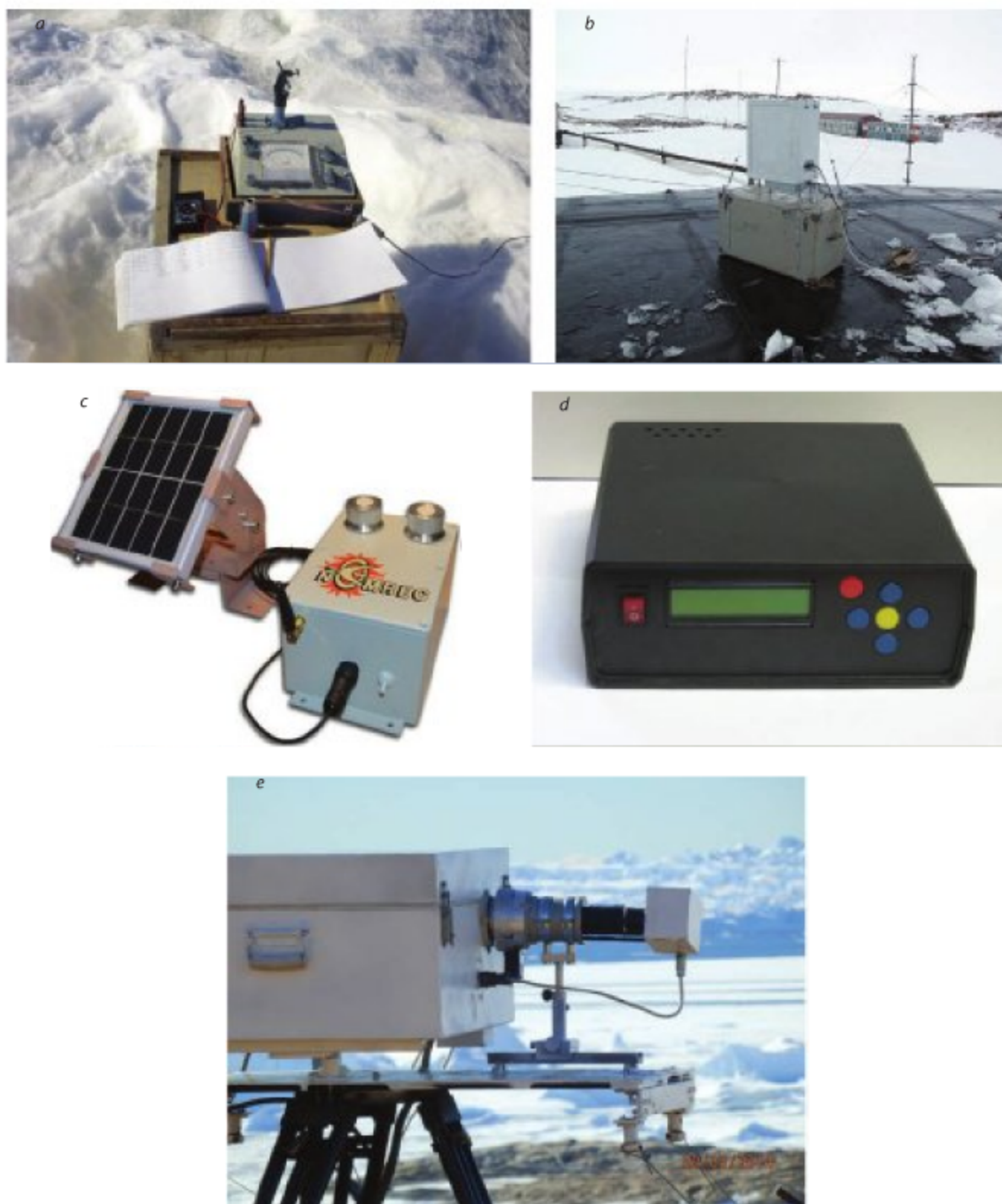
Рис. 2.1. Приборы для измерения интенсивности солнечного УФ-излучения, концентрации озона и двуокиси азота: а – фильтровый озонметр M124-M; б – спектрорадиометр «ПИОН-УФ-II»; в – фильтровый радиометр «ПИОН-ФН» с солнечной батареей; д – измеритель концентрации приземного озона на основе ПГС; е – спектрограф изображения MARS-B
