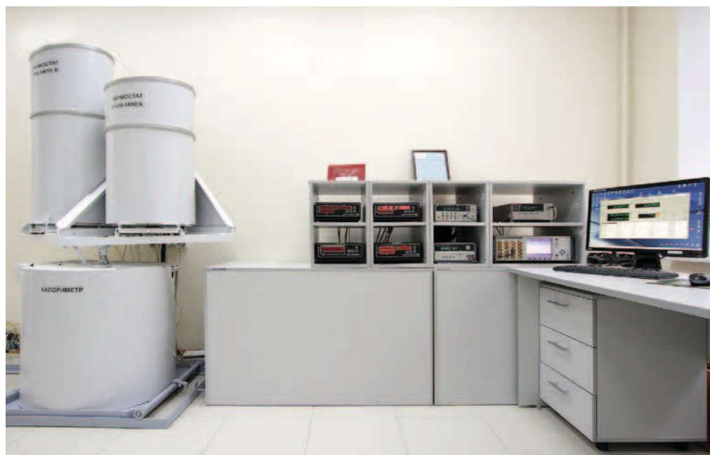
Государственный первичный специальный эталон единиц удельной энтальпии и удельной теплоемкости твердых тел в диапазоне температур от 700 до 1800 °K
