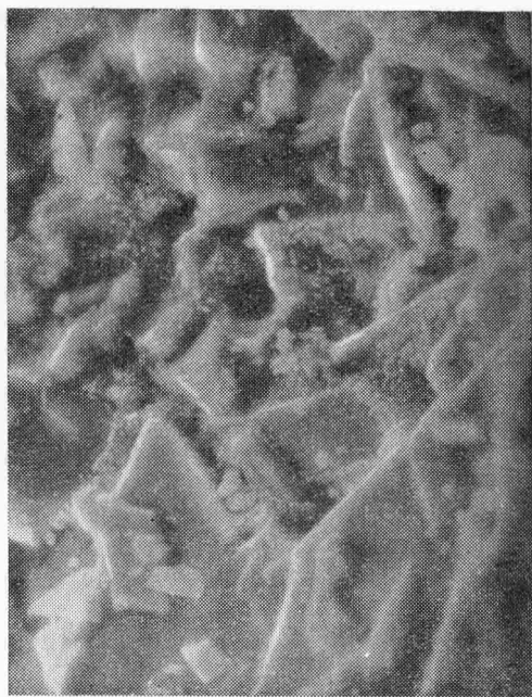
Рис. 31. Поверхность частицы пепла под электронным микроскопом, \times 6330 . Вулкан Толбачик
