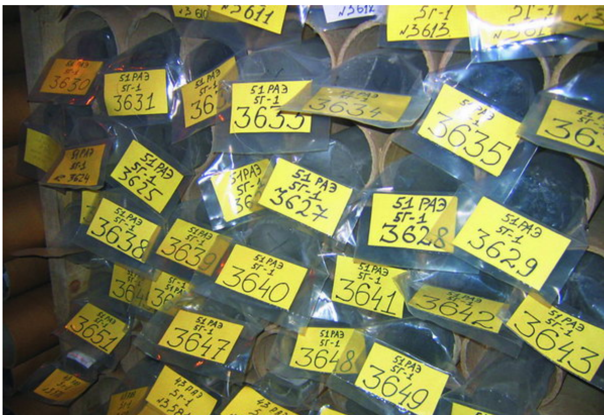
Штабель кернов с указанием глубин в кернохранилище на станции «Восток»
