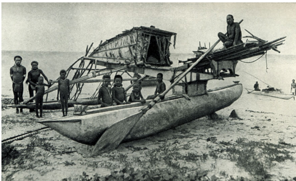
Лодка-однодеревка с балансиром и укрытием (Рифовы острова)
