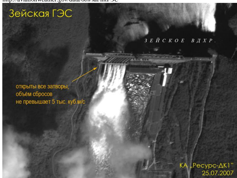
Рис. 50. Самый массовый сброс воды на Зейской ГЭС, достигший 26 июля 2007 г. 5100 м 3 /с (снимок 25.07.2007).
