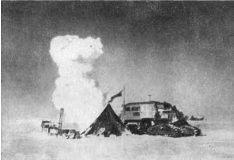
Сейсмический взрыв для измерения толщины льда
