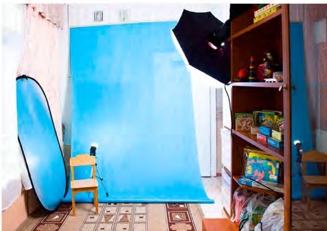
В качестве рассеивателя используется зонт-софтбокс, серебряный зонт на отражение и даже белый потолок помещения (при съёмке групповых портретов). Рисующий свет - основной и самый мощный, передний- боковой. Для подсветки теней используется лайтдиск.
